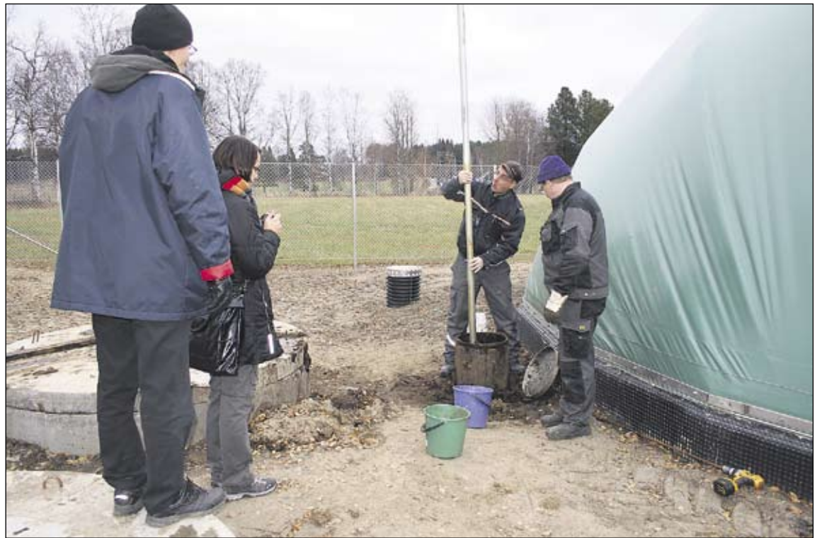
Tutkijat Auvo Sairanen ja Sari Luostarinen seuraavat, kun Pekka Issakainen ja Esko Laakso ottavat näytettä biokaasulaitoksen käsittelyjäännöksestä ravinneanalyysia varten.
