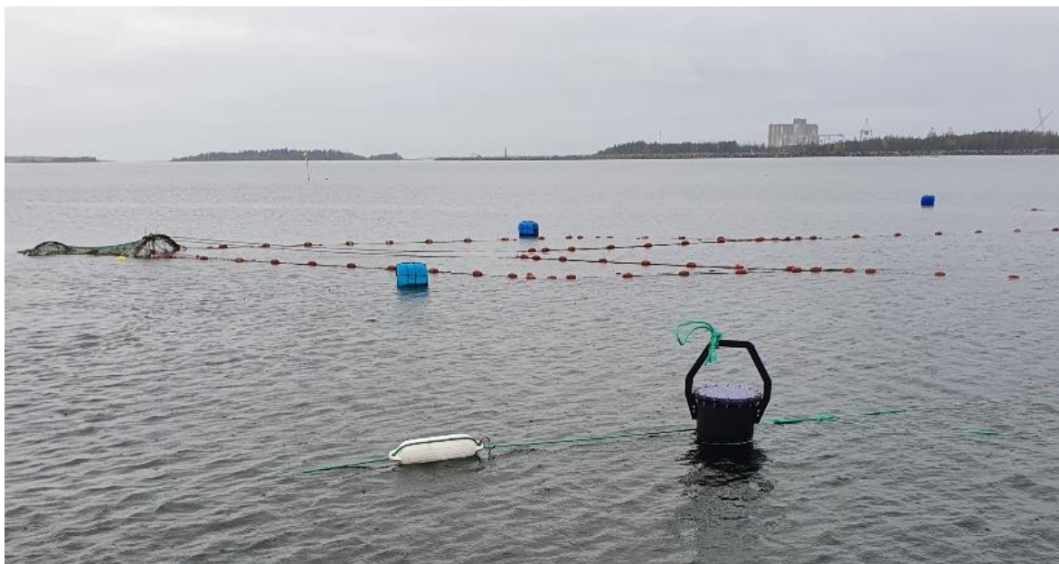
Kuva 5. Liikuteltava hyljekarkotin ankkuroidaan pyydyksen äärelle ja sen paikkaa voidaan tarvittaessa vaihtaa. Kuva: Jarno Aaltonen.
