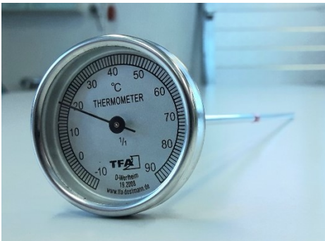
Kuva 3. Säilörehun lämpötilan mittaamisessa käytettiin TFA:n kompostilämpömittaria. Kuvat: Luke/Anna Tamminen.
