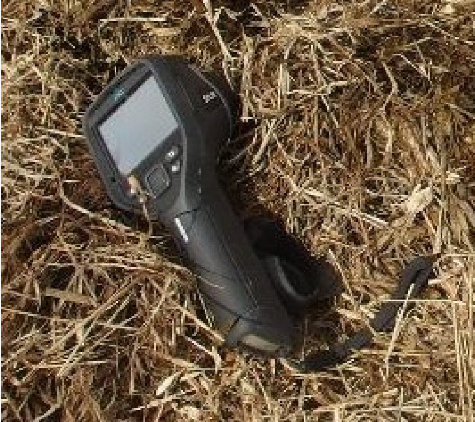
Kuva 2. Lämpökuvauksessa käytettiin Flir E60 -lämpökameraa. Kuva: Luke/Anna Tamminen.
