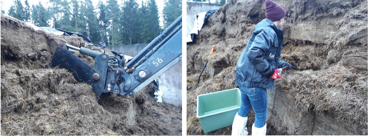
Kuva 1. Rehun irrotus laakasiilosta ja Luken tutkija Marcia Franco ottamassa rehunäytettä. Kuvat: Luke/Katariina Manni.
