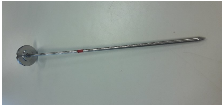
Kuva 3. Säilörehun lämpötilan mittaamisessa käytettiin TFA:n kompostilämpömittaria. Kuvat: Luke/Anna Tamminen.
