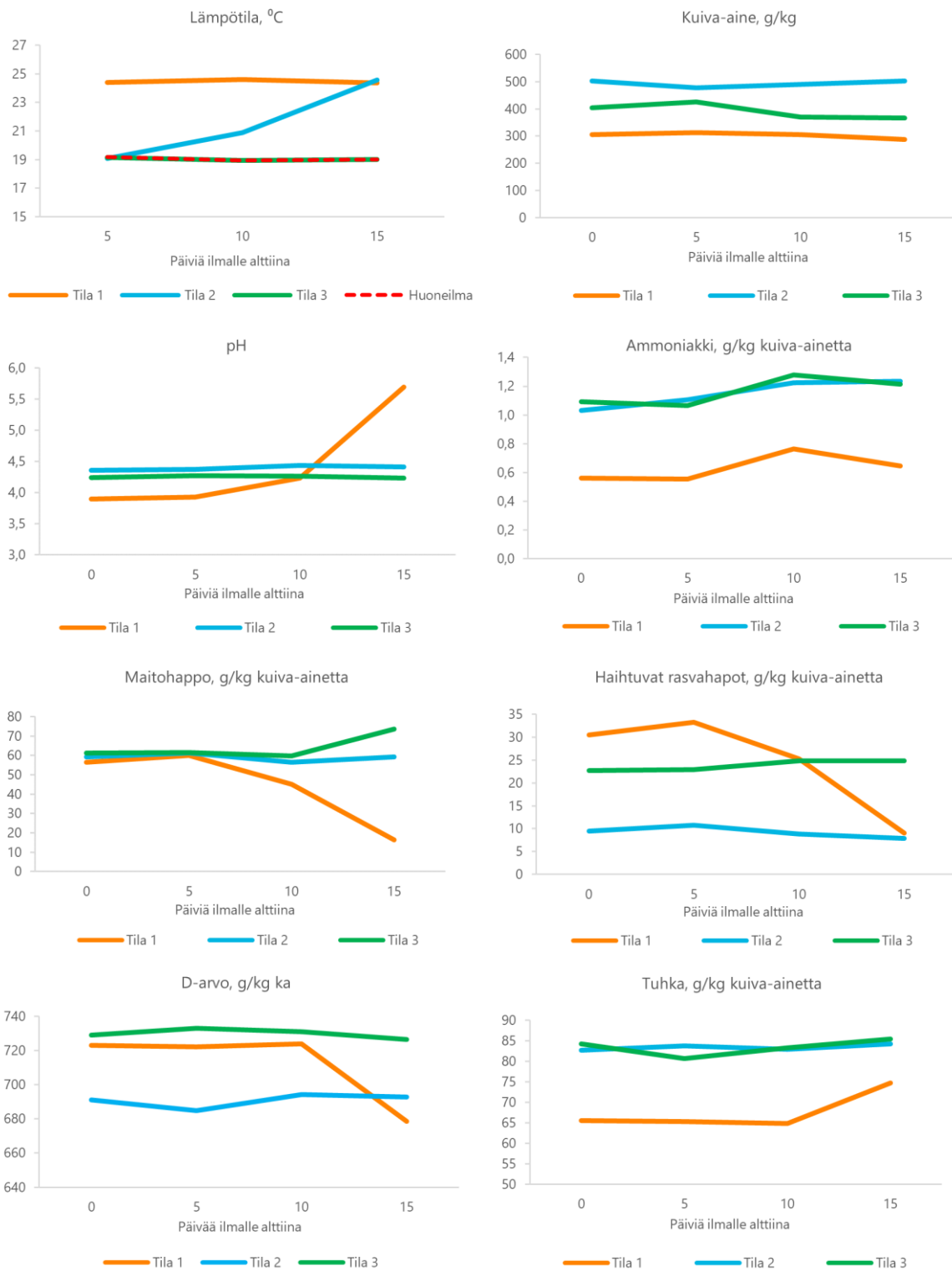
Kuva 10. Muutokset kolmen eri säilörehun lämpötilassa, kuiva-aineessa, säilönnällisessä laadussa, tuhkapitoisuudessa ja sulavuudessa, kun rehuja pidettiin ilmalle alttiina 15 vuorokauden ajan.
