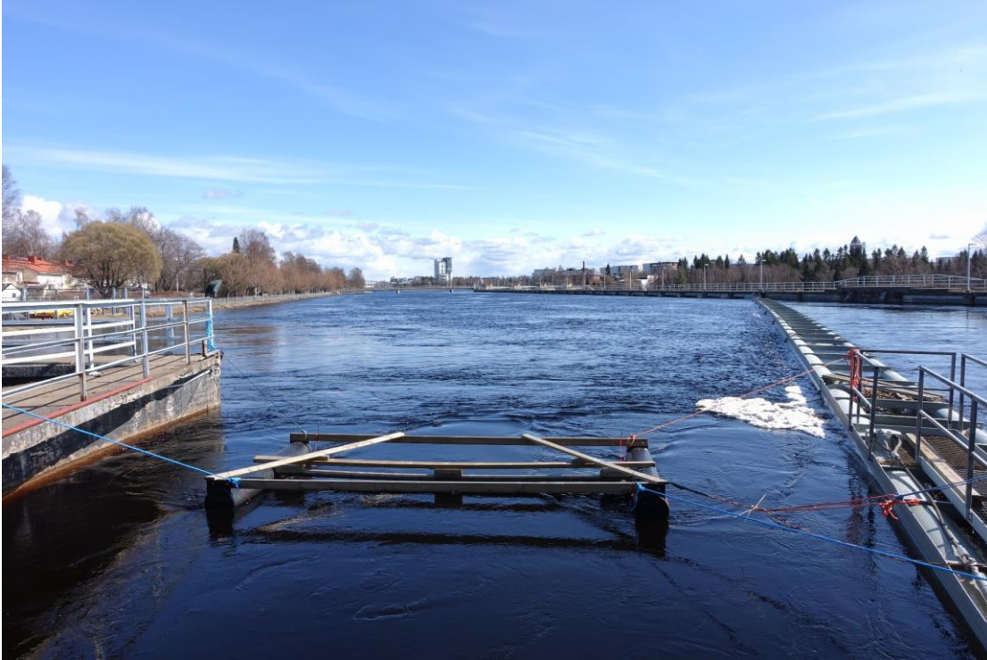
Kuva 28. Merikosken voimalaitoksen yläkanavaan sijoitettu PIT-lukuasema. Aseman antenni ulottui noin yhden metrin verran vedenpinnan alapuolelle. Kuva: Panu Orell.
