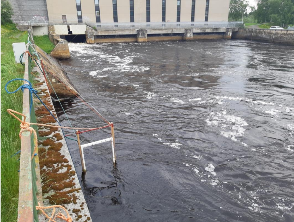
Kuva 29. Merikosken voimalan alakanavan pohjoispuolen PIT-lukuasema. Lukuaseman antenni on valkoisen kehikon sisällä ja se yhdistyy kaapelin välityksellä harmaassa laatikossa sijaitsevaan lukulaitteeseen. Kuva: Panu Orell.
