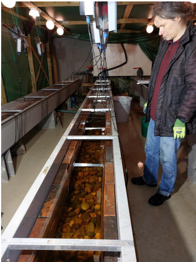
Kuva 56. Ajekokeen koeallas. Tutkija Topi Lehtonen tarkkailee virtausta.
