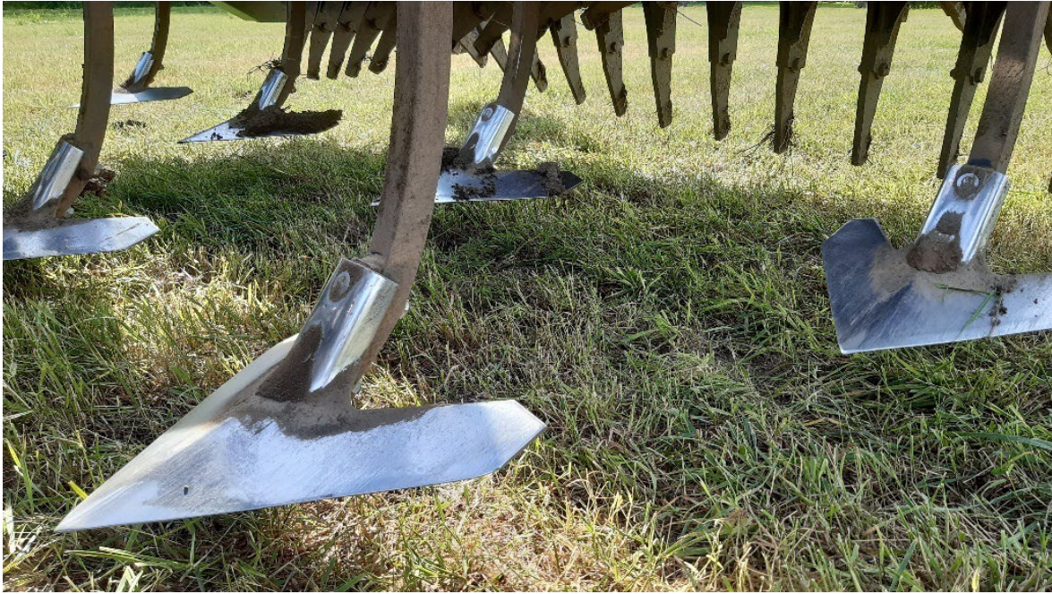
Kuva 11. Edessä KwickFinnin kultivaattoriosan hanhenjalkaterät ja takana roottorin kovapalaterät, jotka olivat tarpeen Jokioisten savimaalla. Kuva Pentti Ruuttunen.
