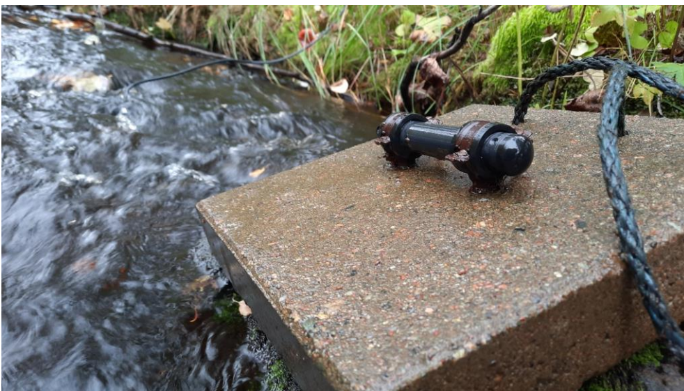
Kuva 6. Veden pinnankorkeuden seurantaan käytetty loggeri kiinnitettiin betoniseen puutarhalaattaan ja asennettiin purojen pohjalle.
