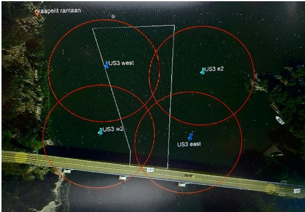
Kuva 11. Naantalinaukkoon johtavan Särkän salmen sillan (silta kuvassa alhaalla) pohjoispuolelle pohjaan ankkuroidun neljän Ace Aquatec US3-karkottimen sijainnit. Yksittäisen karkottimen laskennallinen vaikutusalue merkitty punaisella ympyrällä. Kuva: TR Marine Oy.
