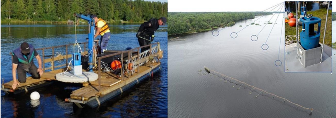
Kuva 12. Vasen kuva: Betonipainolla varustetun US3-karkottimen lasku lijokeen. Kuva: Petri Suuronen. Oikea kuva: Viisi karkotinta oli pääuomassa ja yksi sivu-uomassa linjaan sijoitettuna. Karkottimien lähellä olleen patopyydyksen aita näkyy kuvassa etualalla. Kuva: Lari Veneranta
