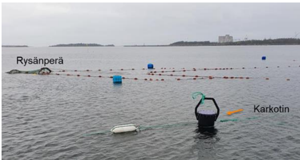
Kuva 5. Ponttooniryssä perän viereen asennettu mobiilikarkotin. Kuva: Jarno Aaltonen
