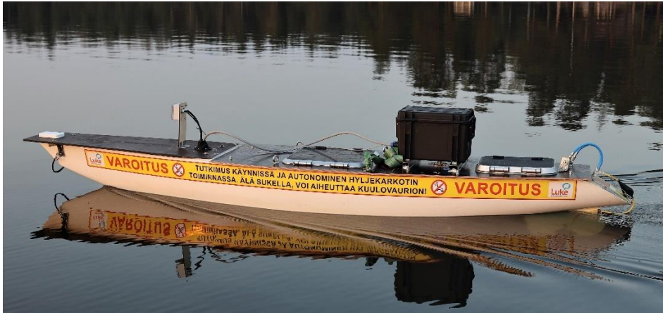
Kuva 13. Autonomisesti liikkuvan hyljekarkottimen kehitysversio (laitealusta), jonka avulla on voitu pilotoida laitteen tarvitsemia erilaisia teknologioita ja ominaisuuksia. Kuva: Esa Lehtonen
