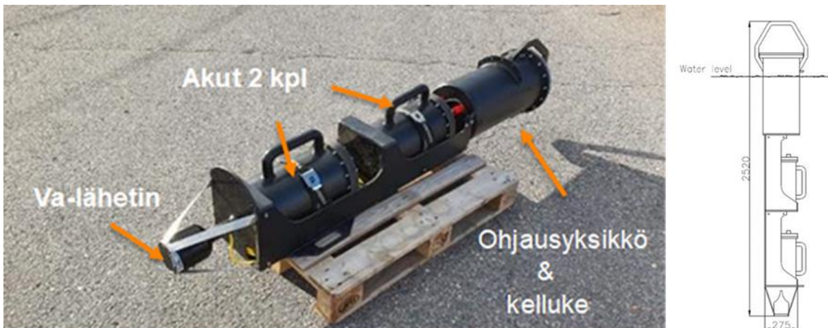
Kuva 4. Liikuteltava mobiilikarkotin. Oikealla olevassa piirroskuvassa karkottimen perusrakenne ja asetelu mereen, jolloin vain laitteen ylin osa on näkyvässä pinnalla. Varsinainen karkotin (Va-lähetin; vedenalainen lähetin) on laitteen alaosassa. Kuva Arwell-Tekniikka Oy. Piirros Modul Plastic Oy.
