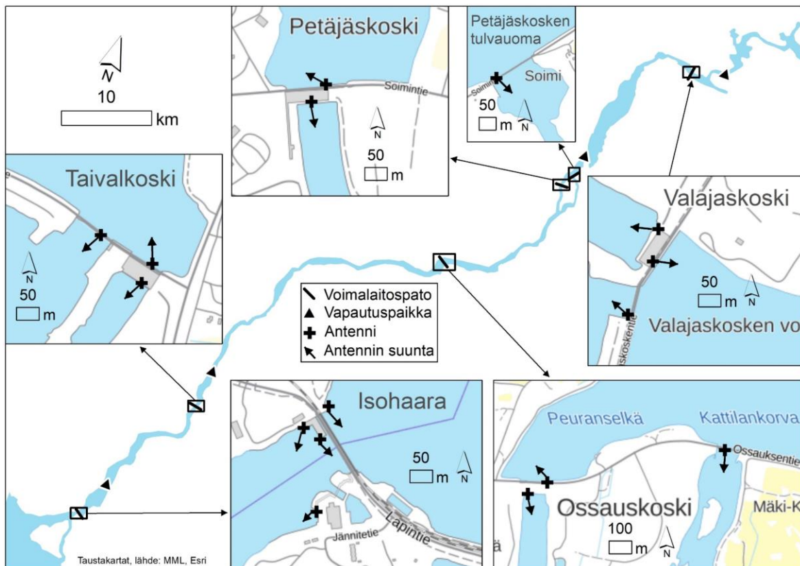
Kuva 2. Radiolähettimillä merkittyjen vaelluspoikasten vapautuspaikat sekä kiinteiden radiovastaanottimien ja -antennien sijoituspaikat Kemijoen viidellä alimmalla voimalaitoksella ja niiden ohjuusutuspadolla.
