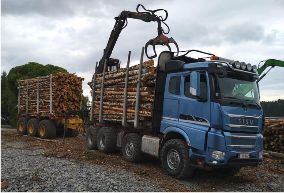
Kuva 14. Heikosti kantavalle tieverkostolle varusteltu puutavara-ajoneuvoyhdistelmä (kuva: Alpo Niiranen).
