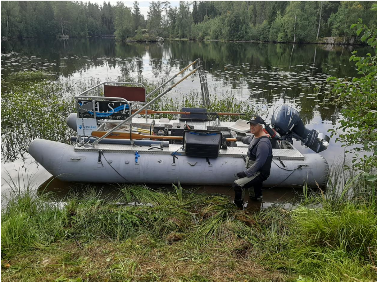
Kuva 3. Sähkökalastuksessa käytetty vene. Veneessä oli kuljettajan lisäksi kaksi henkilöä haavimassa taintuneita kaloja säilytysastioihin. Kuva: Teppo Vehanen.
