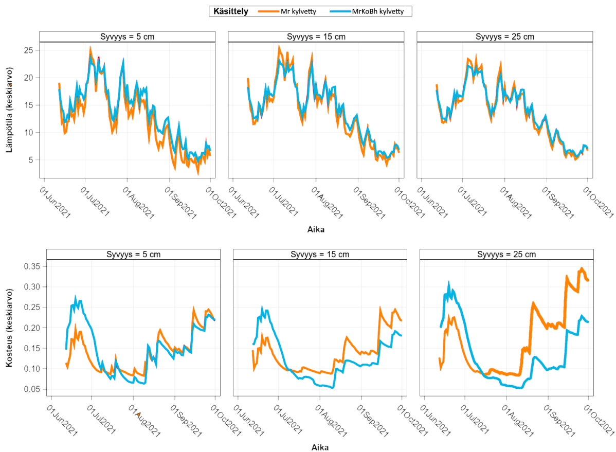
Kuva 14. Lysimetrien peittokerroksien (5 cm ja 15 cm) sekä rikastushiekkakerroksen (25 cm) keskimääräiset keskimääräiset lämpötilat (°C) ja tilavuuskosteudet seurantavuoden 2021 aikana Lysimetrikokeessa 1 (n=4).
