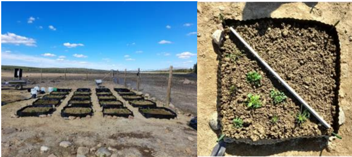
Kuva 8. Vasemmassa kuvassa kasvualustaruudut Rautuvaaran koalueella ruutukokeessa 2. Oikeassa kuvassa 1 m 2 kokoinen koeruutu, jonka vasemmalle puolelle on istutettu taimet ja oikealle kylvetty siemenet (Kuva: Marleena Hagner/Luke).
