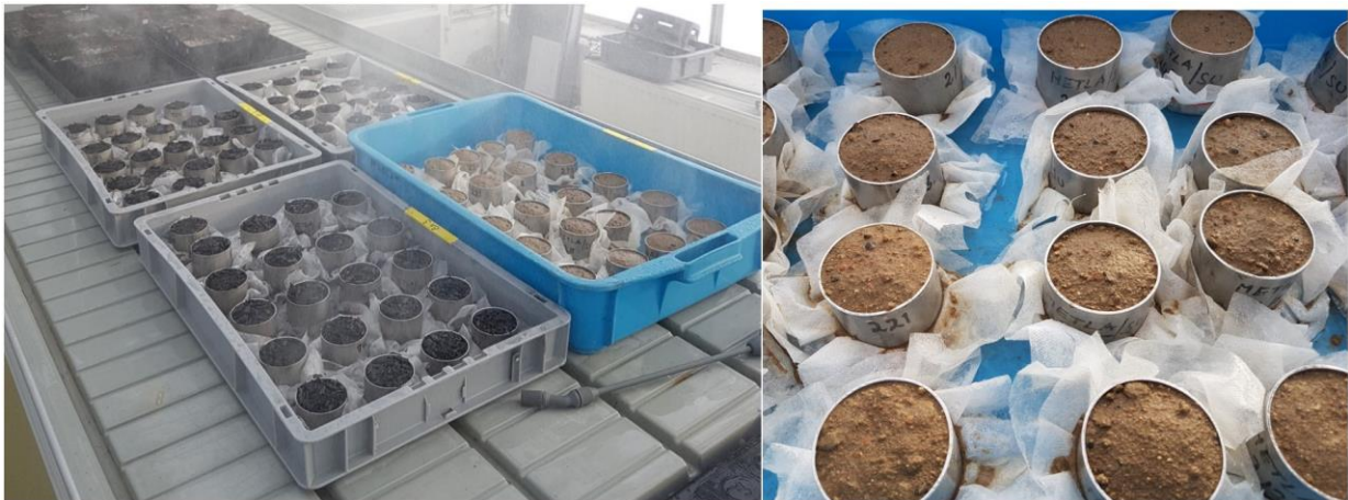
Kuva 2. Näyteliieriöt (halkaisija 5 cm, tilavuus 155 ml) kostutuskokeessa. Kustakin biohiilityypistä oli kolme toistoa ja lisäksi moreenikontrollit (Kuva Hanna Ruhanen/Luke).
