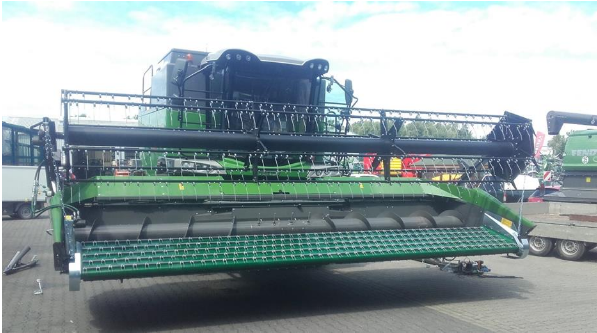
Kuva 28. Vaihtoehtona edellisen kuvan kokonaiseen noukkivaan pöytään on tavallisen leikkuupöydän eteen asennettava pelkkä mattonoukin, joita saa eri levyisinä. Kuva: A. den Dekker & ZN. B.V., https://twitter.com/AdenDekker/status/881891742416601095
