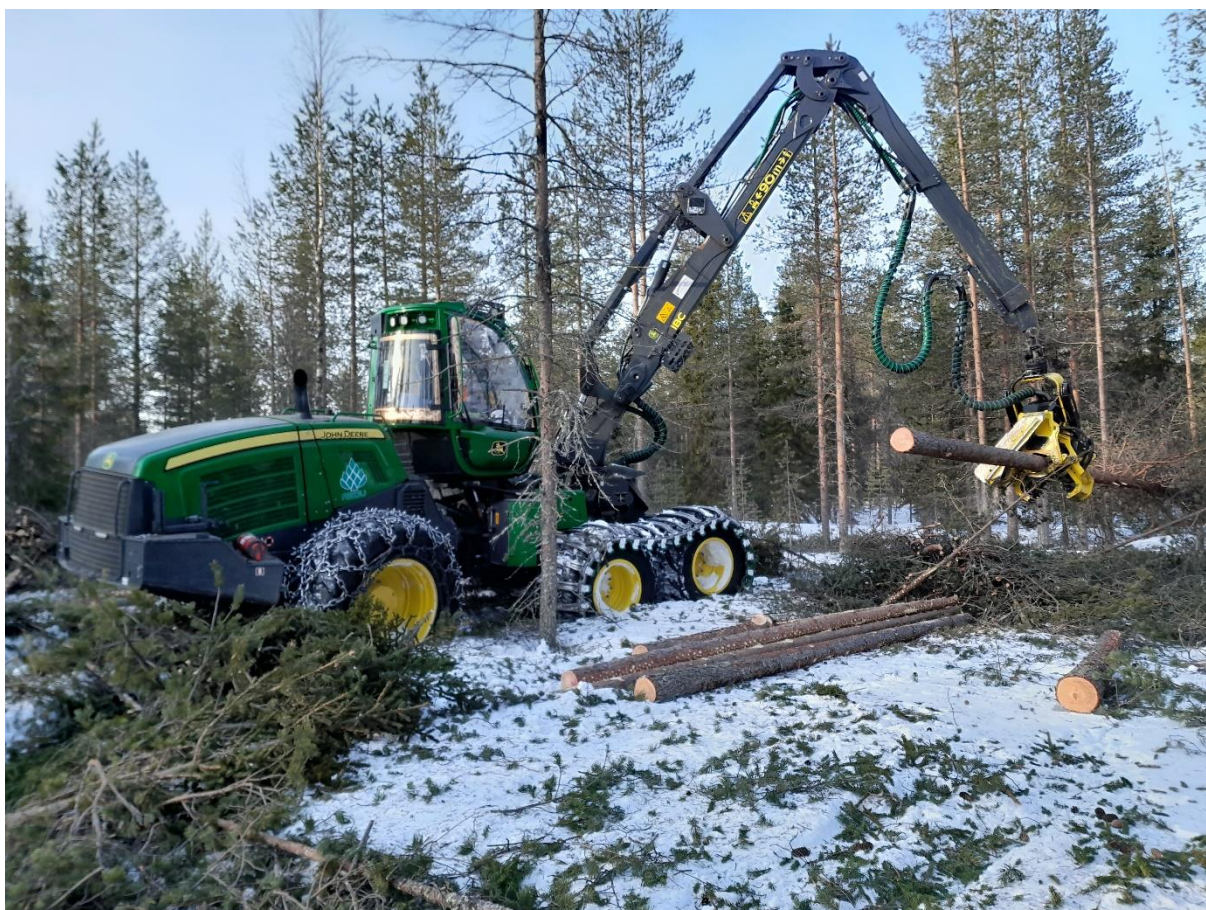
Kuva 1. Tutkimushakkuut tehtiin John Deere 1170G hakkuukoneella, joka oli varustettu H413 hakkuulaiteella.
