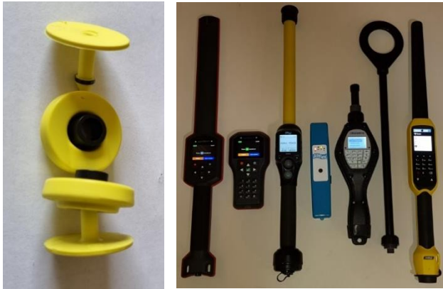
Kuva 30. Vasemmanpuoleisessa kuvassa elektroninen korvamerkki. Kuva: Paliskuntain yhdistys/Mika Tervonen. Oikeanpuoleisessa kuvassa muutamien valmistajien e-merkkien lukijalaitteita. Kuva: Luke/Mikko Laajalahti.
