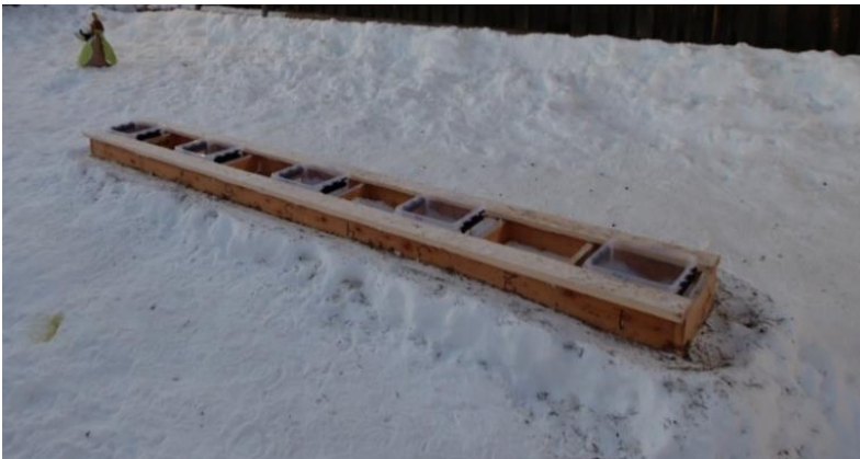
Kuva 10. Ravinnonvalintakokeissa käytetty astia, jossa voi olla viisi eri rehulaatikkoa. Kuva: Luke/Henri Vanhanen.
