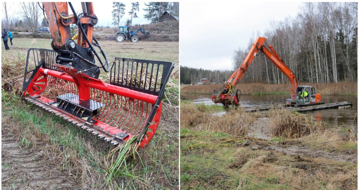
Kuva 25. Leveä niittokauha leikkaavalla haralla on tehokas niittoväline. Rantakasvi isosorsimoa päästään niittämään vesiltä käsin kelluvan kaivinkoneen avulla. Kuva: Vanajavesikeskus.
