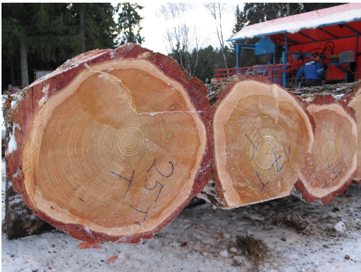
Kuva 23. Lehtikuusen pinta- ja sydänpuun välillä on jyrkkä sävyero. Punkaharjun tutkimusmetsästä kaadettujen 80-vuotiaiden siperianlehtikuusten tyvitukkeja sahauspaikalla. MV
