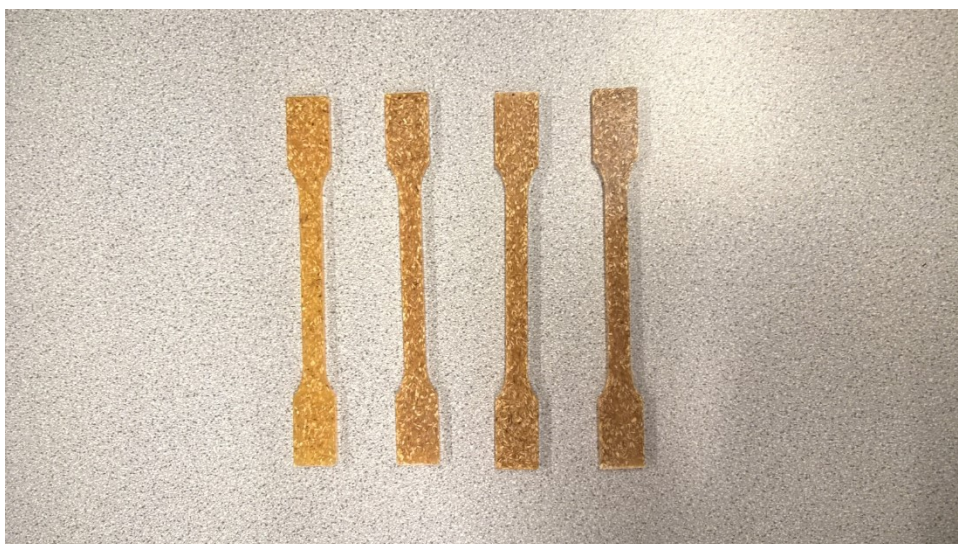
Kuva 17. Lujuustestejä varten valmistettuja eri tilavuusosuuksia (10–40 %) pajupuujaetta sisältäviä biokomposiittikappaleita
