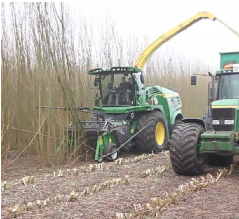
Kuva 6. Energiapuupöydällä varustettu ajosilppuri pajun suora haketuksessa. Kuva: Henriksson Salix AB.
