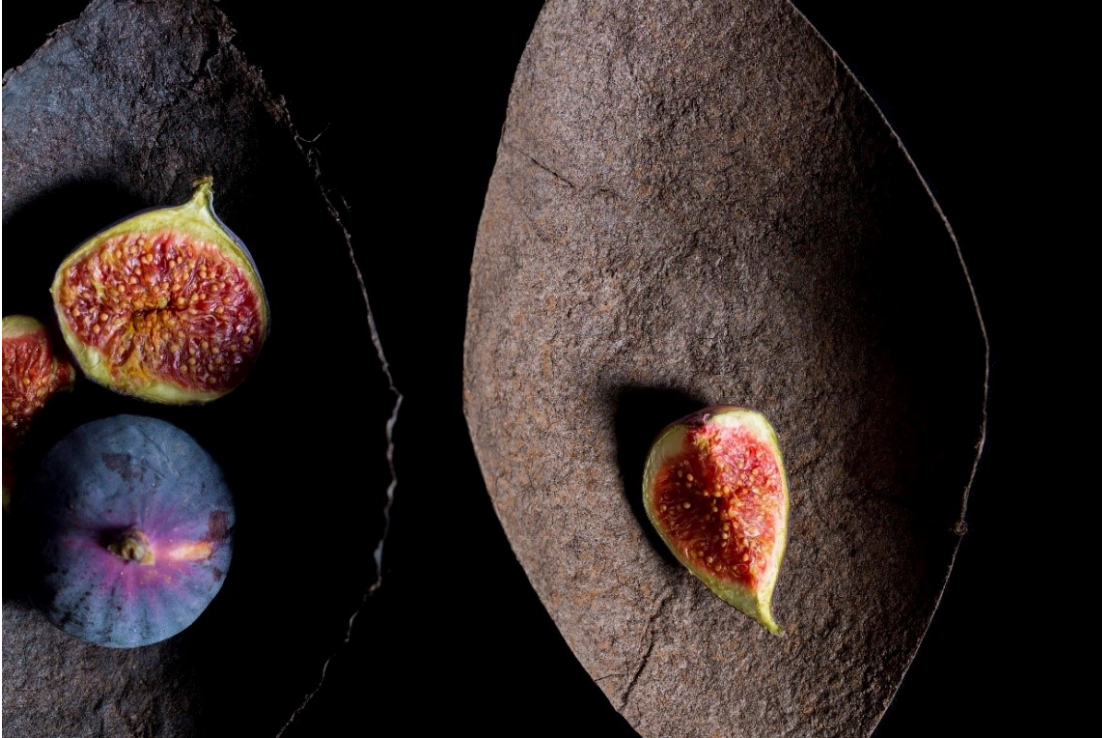
Kuva 26. Kertakäyttöisiä astioita pajun sisäkuoren kuidusta. Ruskea väri on luonnollinen. Eve- liina Juuri, Sanna-Liisa Järvelä & Jinze Dou, Aalto-yliopisto / CHEMARTS 2017. Kuva: Eeva Suor- lahti
