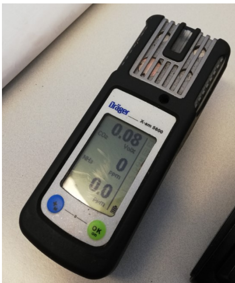
Kuva 4. Kuivikepatjasta mitattiin kaasut Drägerin x-am 5600 –mittarilla. Kuva: Luke/Anna Tamminen.
