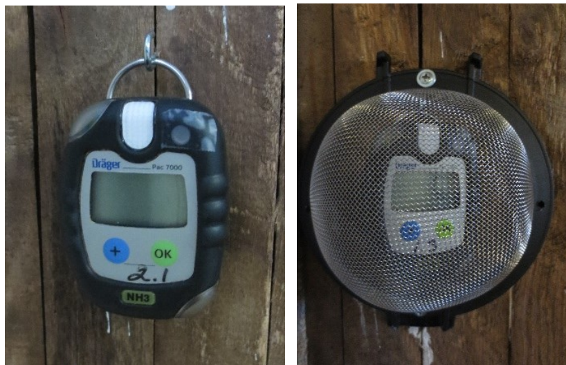
Kuva 3. Ilman ammoniakkipitoisuuden mittauksessa käytetty mittauslaite ja suojakuppu. Kuvat: Luke/Katariina Manni.
