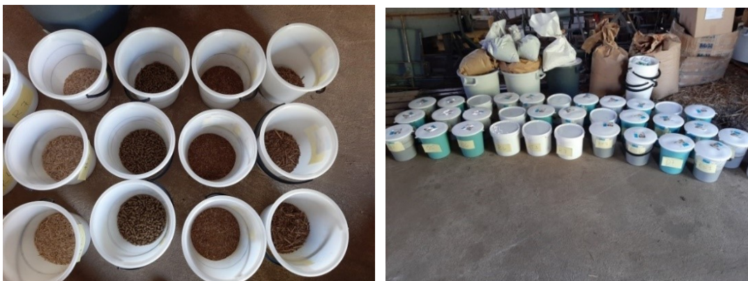
Kuva 1. Kuivikemateriaalit koeastioissa (vasemmanpuoleinen kuva) ja satunnaistettuun järjestykseen asetetut kuivikelietelantaseokset (oikeanpuoleinen kuva). Kuvat: Maarit Hellstedt.
