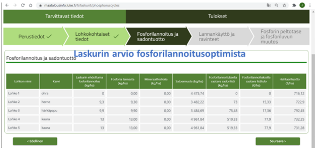
Kuva 16. Fosforikiertolaskurin tuottama arvio annettujen tietojen perusteella lohkojen taloudellisesti optimaalisesta fosforilannoituksesta sian lietalannalla. Mineraalilannoitus ei ole kannattavaa. Laskuri arvioi fosforilannoituksella saavutettavan sadonlisän ja lisätulon.
