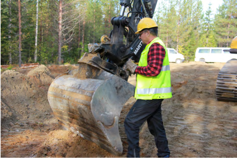
Kuva 63. Työlaite tuetaan maahan huoltotöiden ajaksi.
