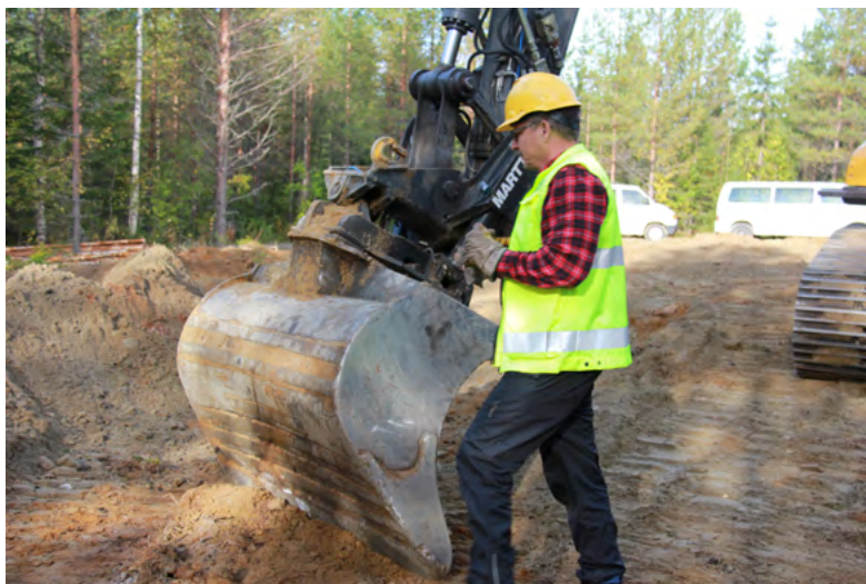
Рисунок 63. При проведении технического обслуживания машины рабочий орган должен находиться на земле в устойчивом положении.
