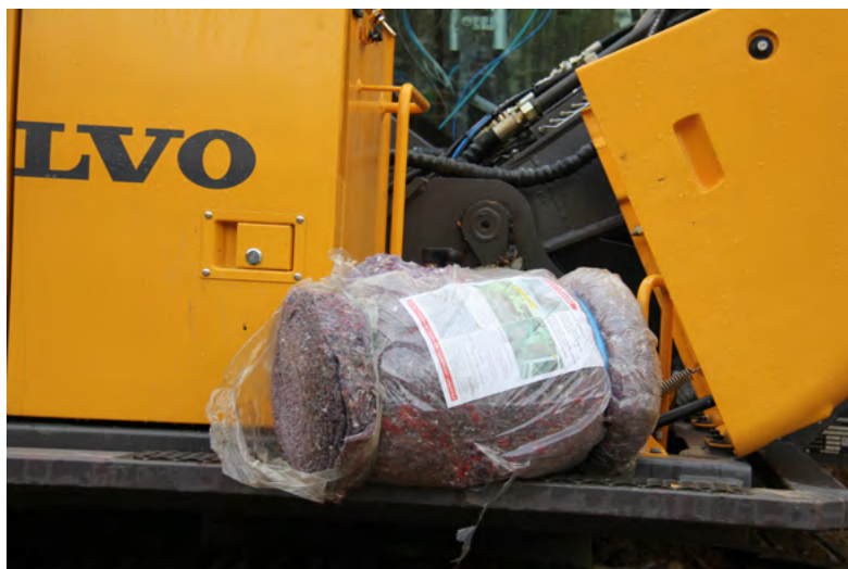
Рисунок 64. Впитывающий текстиль для очистки почвы от нефтепродуктов входит в комплект поставки машины.
