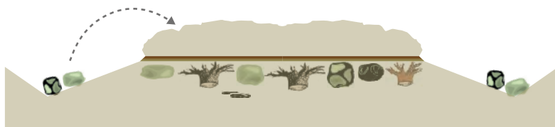
Рисунок 16. Строительство боковых канав.
