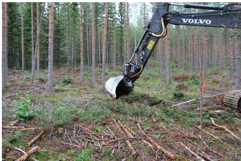
Рисунок 7. Сначала пень поддевается ковшом экскаватора.
