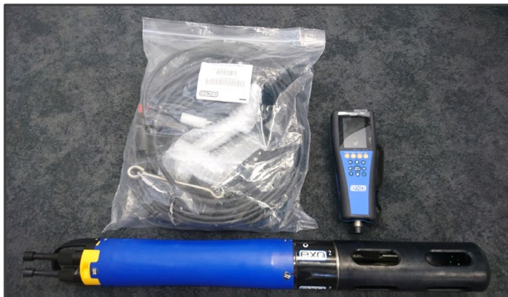
Kuva 3. EXO2 -laite, käsinäyttö ja kaapeli mahdollistaa mittaukset laitosten ympäriltä ja myös eri syvyyksistä. Kuva: Jari Niukko.
