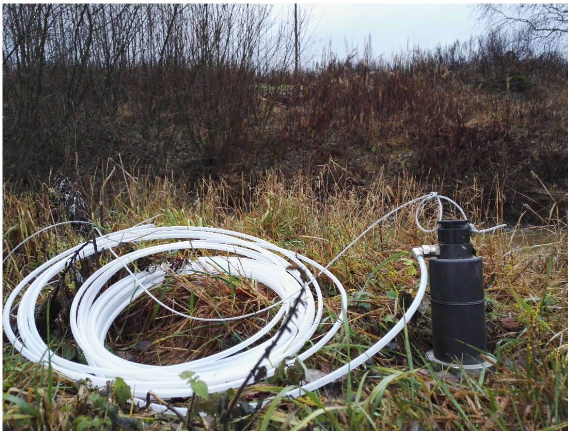
Kuva 40. SorbiCell-keräin odottamassa asennusta. Kuva: Pyhäjärvi-instituutti.
