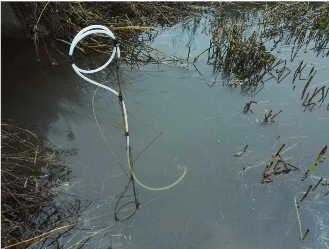
Kuva 42. SorbiCell-passiivinäytteenotin toiminnassa. Kohteessa on oltava riittävä vedenkorkeus koko käyttöjakson ajan. Kuva: Pyhäjärvi-instituutti.
