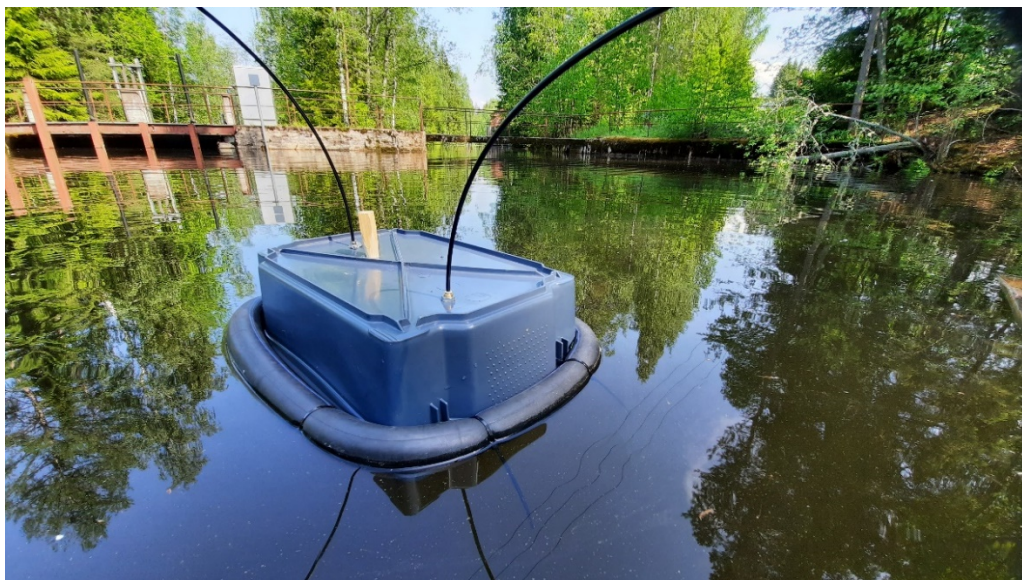
Kuva 2. Metaanin ja hiilidioksidin diffuusiomittaus kelluvalla kammioilla. Kaasupitoisuuksia kammion ilmatilassa mitataan kerran sekunnissa mukana kulkevalla analysaattorilla. Kammion annetaan kulkea vapaasti virran mukana veden turbulenssihäiriöiden vähentämiseksi. Kuva: Jukka Alm.
