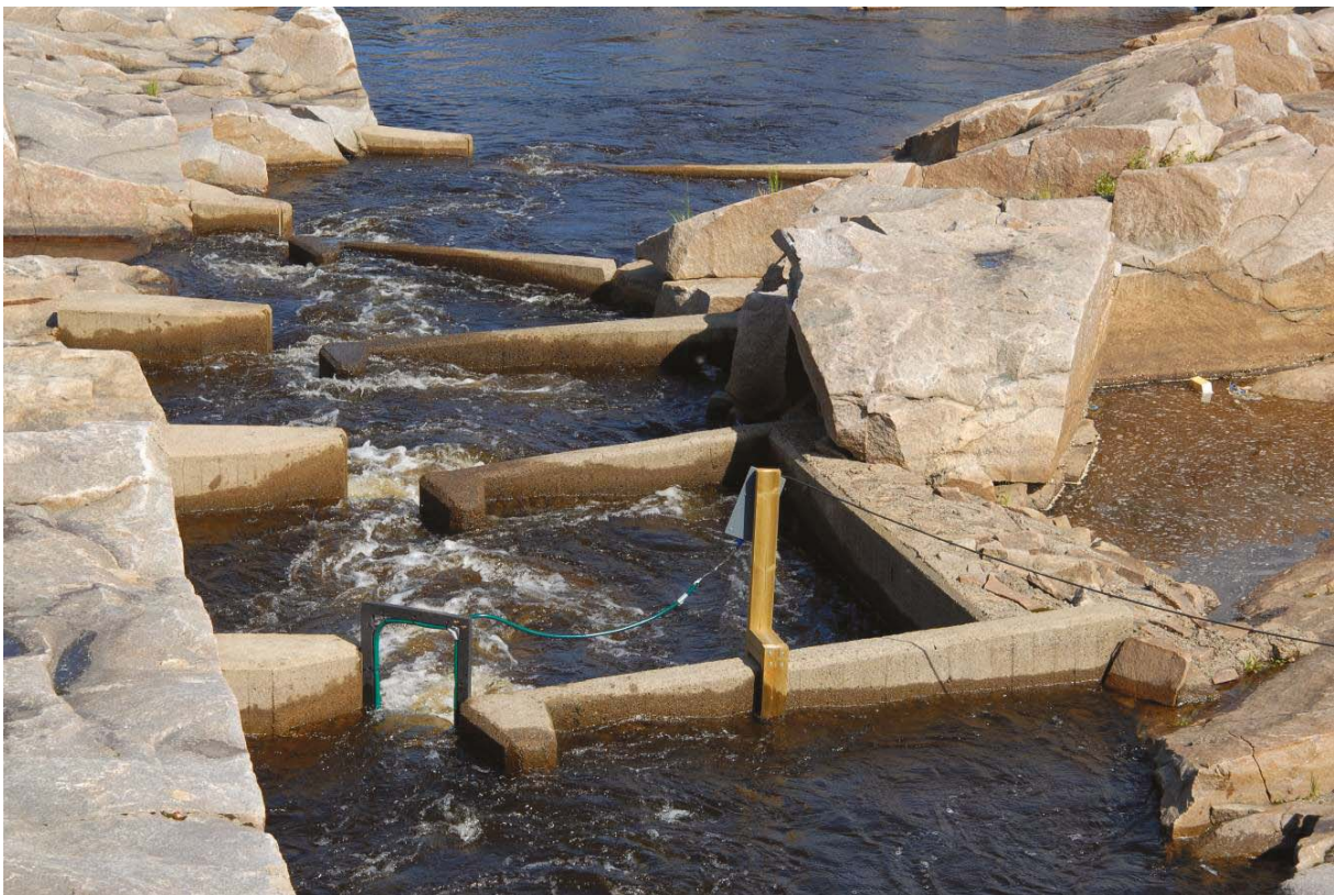
Kuva 4. PIT-mikrosirumerkintää hyödynnettiin Merikosken kalatieen vaelluskalaturkimuksissa. Kuvassa PIT-merkkien lukuasema 3 (kts. kuva 3) asennettuna Merikosken kalatieen pystyrakoon. Kuva: Panu Orell.
