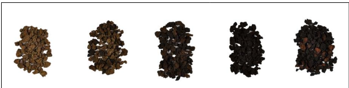
Kuva 3. Paahdetut lietteet lämpötiloissa 200, 235, 275, 300 ja 450 °C vasemmalta lukien. Paahto aika 15 min.
