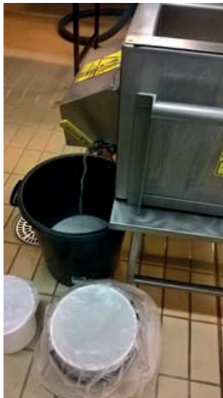
Kuva 11. Vesi- ja öljyfaasin talteenotto reaktorisäiliön alaventtiin kautta
