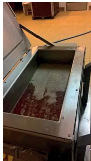
Kuva 10. Hydrolysoitu vatsalieveseos, jossa öljy erottunut pinnalle.
