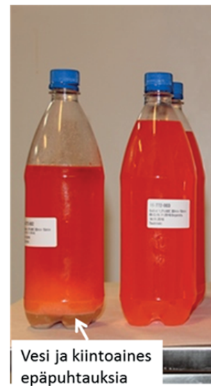
Kuva 12. Separaattori ja kalaöljyä ennen ja jälkeen separoinnin.
