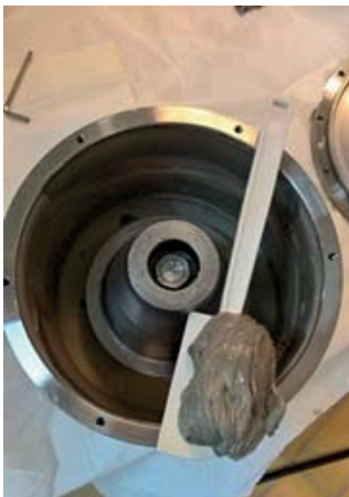
Kuva 17. Sentrifugoimalla eristetyt fraktiot vasemmalta oikealle: sakka, vesi- ja öljyfraktio.
