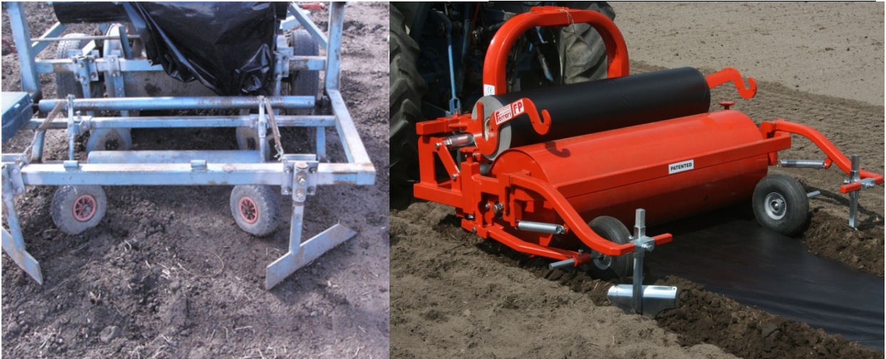
Kuva 4. Katteiden levitykseen tarkoitettuja koneita. Perinteisen ”Räpi”-mallin (vas.) voi unohtaa paperipohjaisia katteita levitettäessä ja etsiä modernimpaa kalustoa (oik). Kuvat: Kari Tiilikkala (vas.), Jukka Salonen (oik.).
