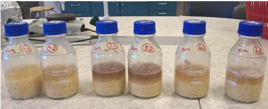
Kuva 1b. Näytteet 4–6 (rinnakkaiset) 5 vrk:n fermentoinnin jälkeen. Näytteissä 5 on selvästi havaittavissa muita näytteitä tummempi vesifaasi ja kiinteän faasin perunankuori-partikkelit ovat hajonneet pienemmiksi kappaleiksi.
