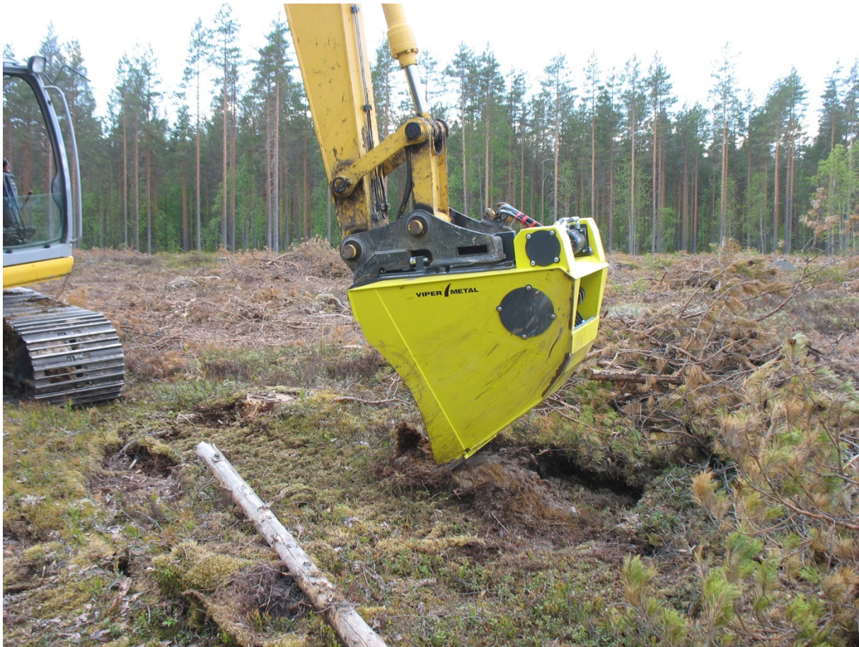
Kuva 16. Metsänuudistamiseen suunnitellussa monitoimikauhassa yhdistyvät ojakauha ja seulakauha. Kauhalla voi laikuttaa, kylvää siemenet, peittää kylvös seulomalla, mätästä ja kaivaa ojaa. (Kuva Pekka Helenius)
