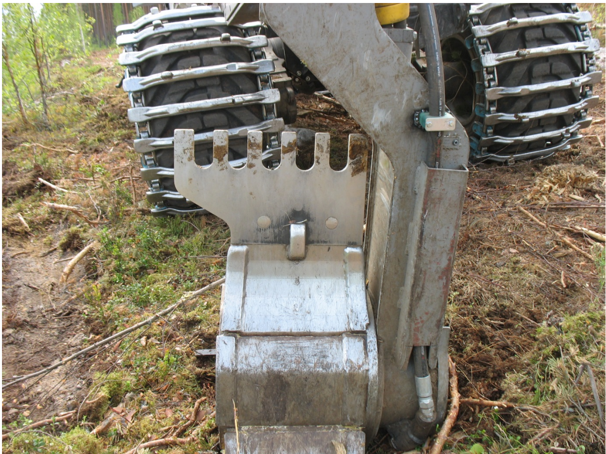
Kuva 15. Männyn kylvöalojen muokkaukseen suunniteltu terä jatkuvatoimisessa laikkurissa. (Kuva Pekka Helenius)
