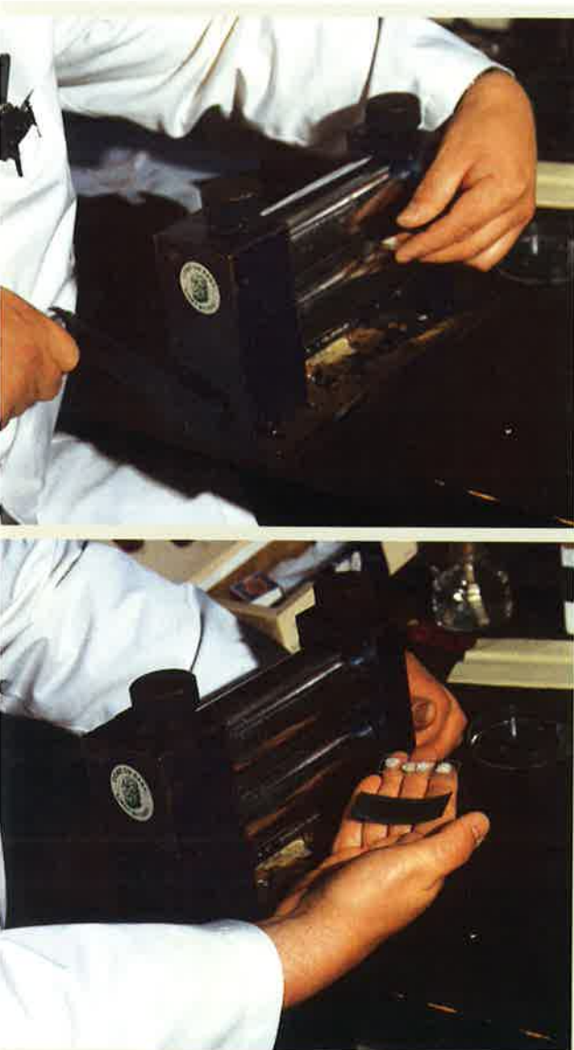
Kuva 31. Suomut asetetaan ohuelle muovilevyllä ja peitetään peltisellä peitinlevyllä (a), minkä jälkeen ne prässäetään suomupuristimen eli suomuprässin avulla (b).
