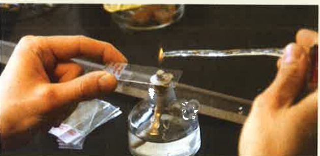
Kuva 38. Crystalbond-vahan sulattaminen otoliitin jäykistämiseksi ja kiinnittämiseksi objektilasiin.
