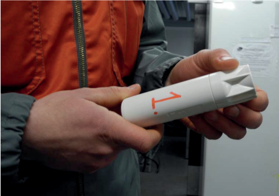
Kuva 1. smaXtec mittausanturi valmiina asennettavaksi suun kautta lehmän pötsiin (Kuva: Sari Kaja-va/Luke).
