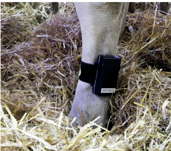
Kuva 4. Lehmien makuukäyttäytymistä mitattiin jalkaan asennettavilla pedometreillä (Kuva: Sari Kajava/Luke).
