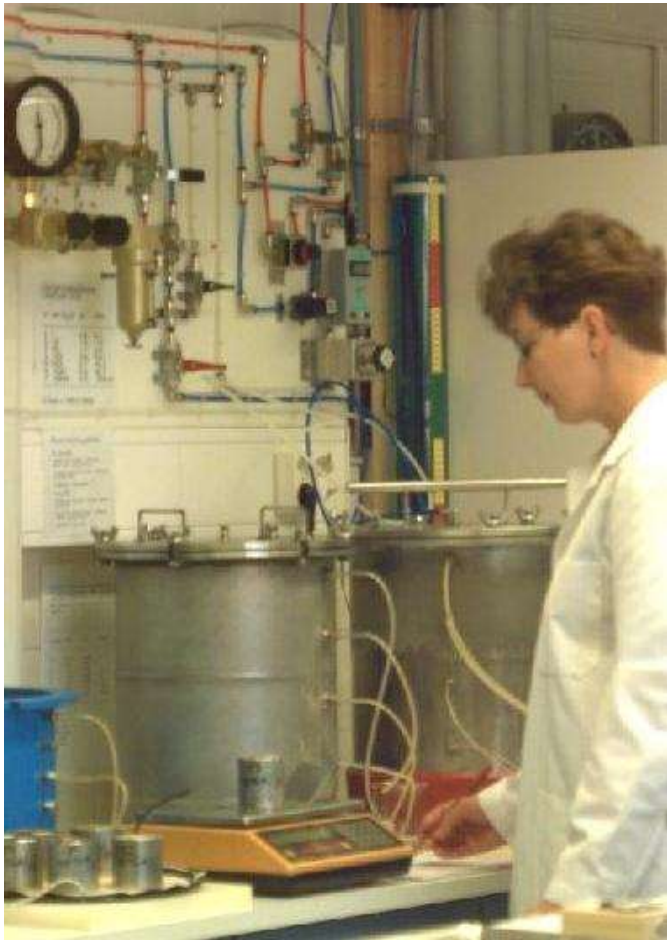
Painelevylaitteisto (SoilMoisture Inc. ja Luke Su), lieriöt k 60, Ø 58 mm => 158 cm 3
