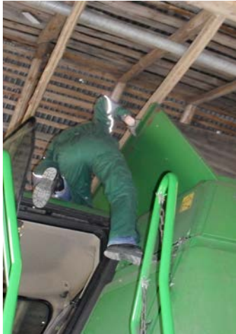
Kuva 61. Isäntä on kehittänyt oman reitin viljasäiliölle, koska kokee puimurin takaa menevän virallisen reitin liian työlääksi (Kuva: Katja Kauppi).
