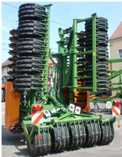
Kuva 54. Maassa olevan pyörärivin keskipyörät pitää muistaa nostaa siirtoajossa, muuten korkea kone voi kaatua ajettaessa kuperalla tienpinnalla (Kuva: ProductFrom).
