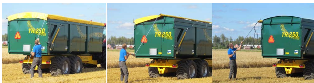
Kuva 42. Rullapeitettä voidaan sekä levittää että myös avata maasta pitkää kampea käyttäen (Kuva: Dometal Oy).
