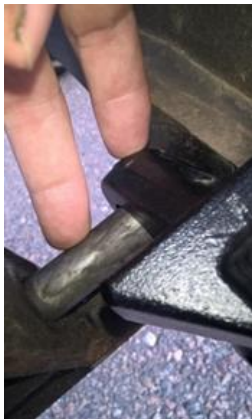
Kuva 25. Ohjaamosta hydraulisesti liikuteltava lukitustappi (vasemmanpuoleisen sormen kohdalla) on mennyt oikein työvälteen korvakkeen (oikean- puoleisen sormen kohdalla) re iän läpi (Kuva: Matts Nysand).
