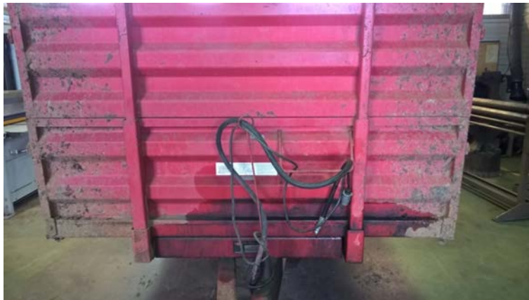
Kuva 41. Tyypillinen puutteellinen kulkutie perävaunun etulaidassa (Kuva: Matts Nysand).
