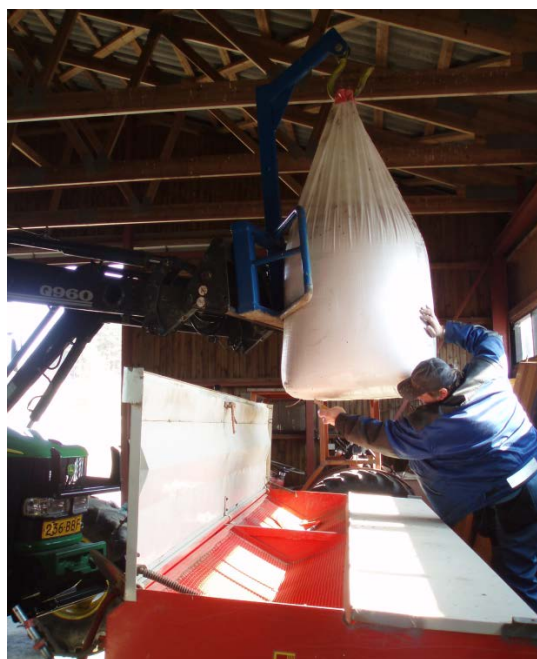
Kuva 52. Vaaratilanne: riippuvan suursäkin alle ei saa mennä eikä ojentaa kehonosia. Vaaratilanteen välttämiseksi avaa säkki pitkävärtisellä veitsellä tai vesurilla (Kuva: Matts Nysand).
