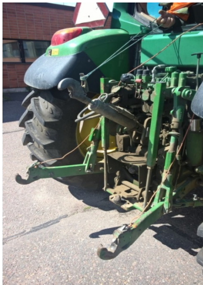
Kuva 31. Kourakytkin on kaksivaiheinen työkonekytkin. Ensin kytetään vetovarsien kourat (alhaalla) työkoneeseen, sen jälkeen työntövarren (ylhällä) koura (Kuva: Matts Nysand).
