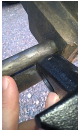
Kuva 26. Vaaratilanne: lukitustappi on mennyt vää- rin työvälteen korvakkeen ohi (Kuva: Matts Ny- sand).
