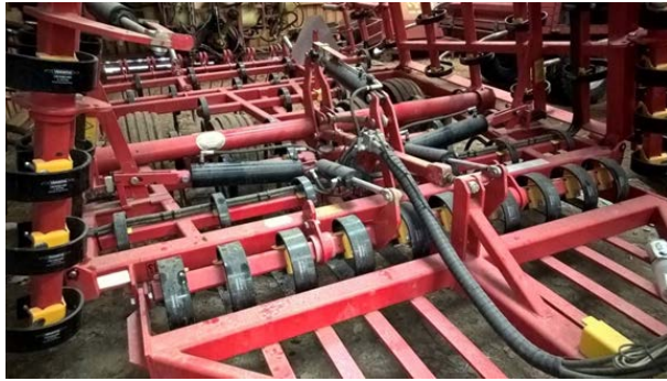
Kuva 53. Äkeen keskellä olevan työsyvyyden säätökohtaan pääsemiseksi pitää tyypillisesti liikkua ja tasapainotella kapeiden rautojen päällä, jotka eivät sovellu kulkuteiksi. Liiku varovaisesti! (Kuva: Matts Nysand)
