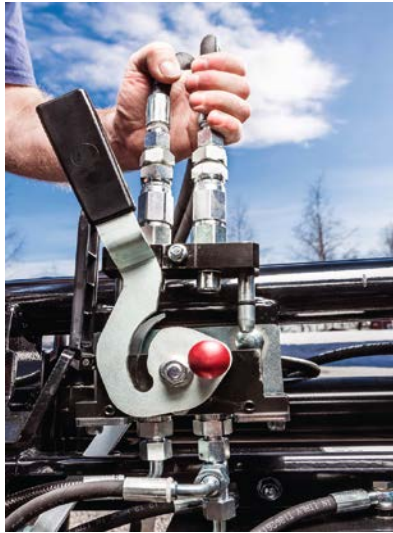
Kuva 29. Erään konevalmistajan ryhmäpikaliitin etukuormaimen ja sen työlaitteen välisille hydraulikkaletkuille (Kuva: Ålö AB).
