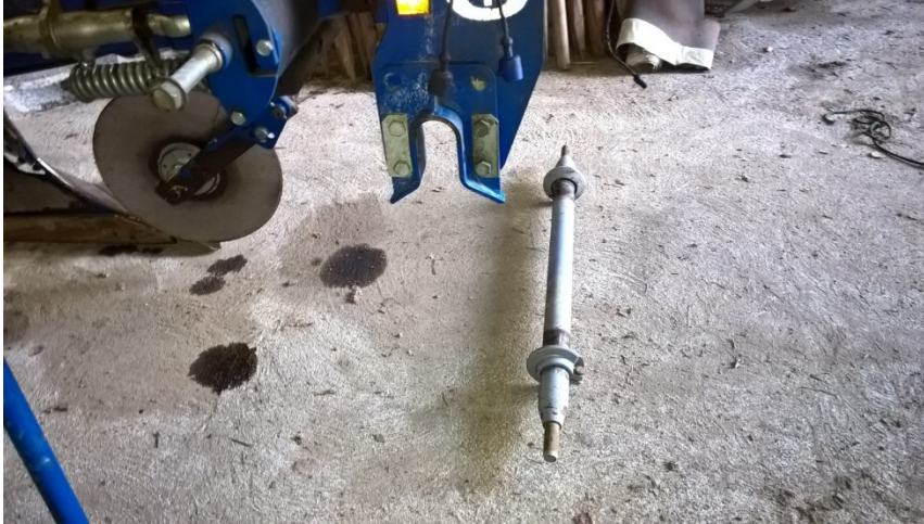
Kuva 32. Vetokarttukytkin on kourakytkimen tapaan kaksivaiheinen työkonetytkin (Kuva: Matts Nysand).
