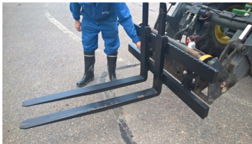
Kuva 24. Etukuormaimen työvälteen alemmat lukituskohdat ovat käden kohdalla, alla lähikuvina (Kuva: Matts Nysand).
