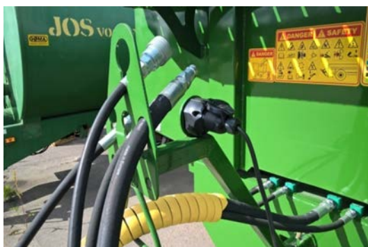
Kuva 34. Esimerkki traktorista irrotettujen letkujen ja valokaapelin ripustuslaitteesta työkoneessa. Valokaapelin pistotulpan sijoituspaikkana toimii sitä varten kiinnitetty valopistorasia (Kuva: Matts Nysand).
