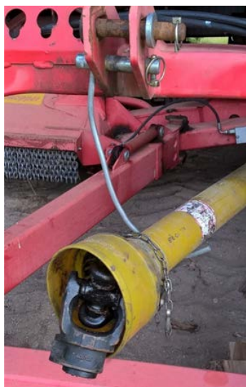
Kuva 35. Esimerkki traktorista irrotetun nivelakselin ripustuslaitteesta: koukku (Kuva: Matts Nysand).
