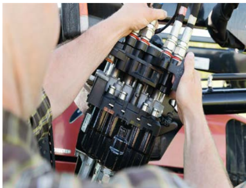
Kuva 28. Erään konevalmistajan ryhmäpikaliitin traktorin ja etukuormaimen välisille hydrauliikkaletkuille (Kuva: Älö AB).
