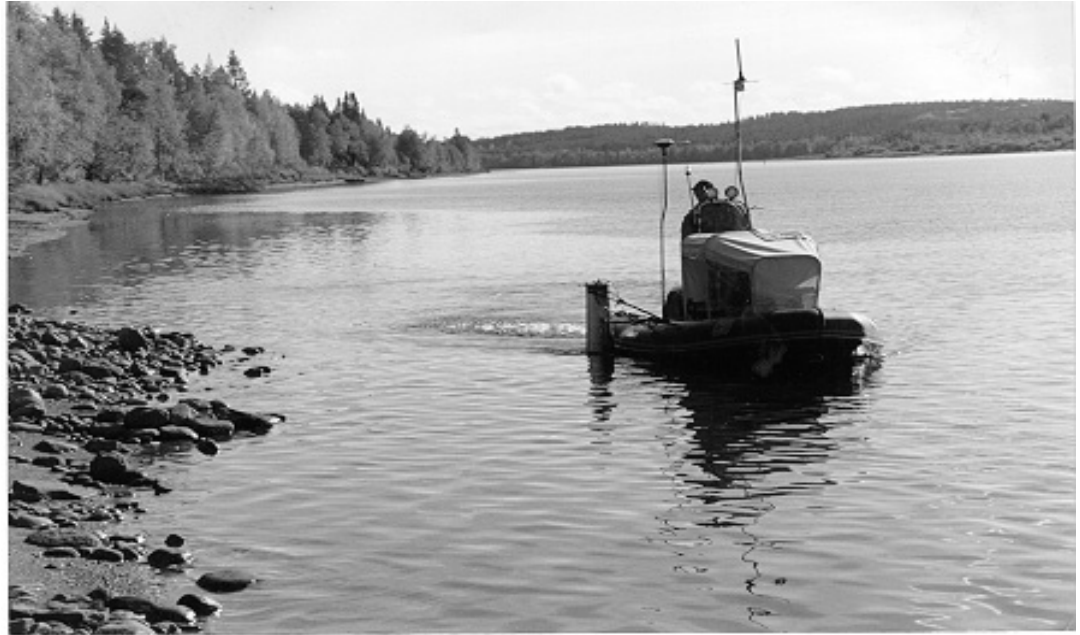
Kuva 2. Kemijoki Oy:n mittaustekniikalla varustettu kumivene mittaamassa patoaltaan pohjan topografiaa (kuva Kemijoki Oy).
