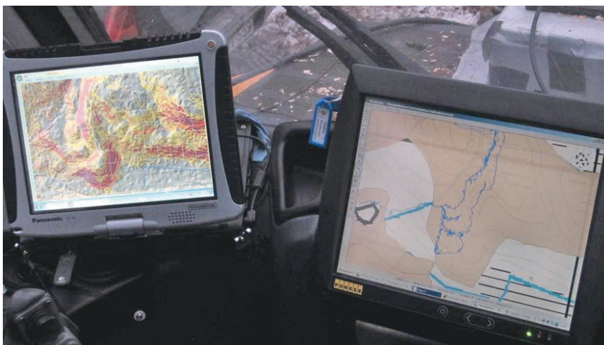
Kuva 14. LoggingMap-demonstraatioissa esitettiin kuljettajalle tarkkaa karttätietoa hakkuukoneen oman näytön rinnalla (kuva: Jari Ala-Ilomäki/Metla).
