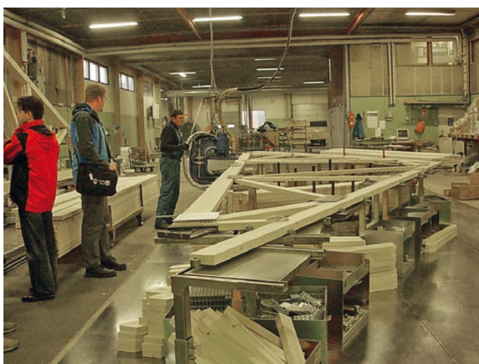
Kuva 4. Kaksi esimerkkiä viljelypuun käyttömahdollisuuksista puutuotteiden jatkojalostuksessa. Vas.: katoristikoiden tekoa kuusisahatavarasta (Karelement Oy, Nurmes) (Kuva: Erkki Verkasalo / Metla), oik.: ikkunanpuiteaihioita erikoissahatusta pystykarsitusta männystä (Sil-Kas Oy, Rantasalmi) (Kuva: Merja Lindroos / Metla).
