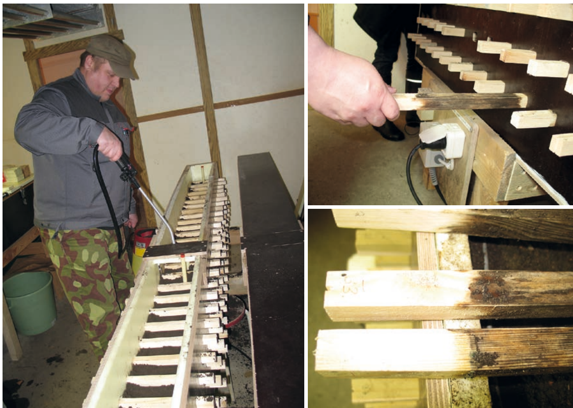
Kuva 38. Kostealla mullalla täytetyssä laatikossa koepalikkaa lahotetaan keskeltä. Lahoamista seurataan mittaamalla lujuuden heikkenemistä (kuvat: Martti Venäläinen / Metla).
