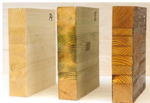
Kuva 34. Eri tavoin käsiteltujen liimapalkkikappaleiden kosteussuhteen muutos vesiupotuksen ja sitä seuranneen tasaannusjakson aikana (vas.) sekä mallikappaleet (oik.).
