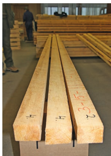
Kuva 4. Kaksi esimerkkiä viljelypuun käyttömahdollisuuksista puutuotteiden jatkojalostuksessa. Vas.: katoristikoiden tekoa kuusisahatavarasta (Karelement Oy, Nurmes) (Kuva: Erkki Verkasalo / Metla), oik.: ikkunanpuiteaihioita erikoissahatusta pystykarsitusta männystä (Sil-Kas Oy, Rantasalmi) (Kuva: Merja Lindroos / Metla).
