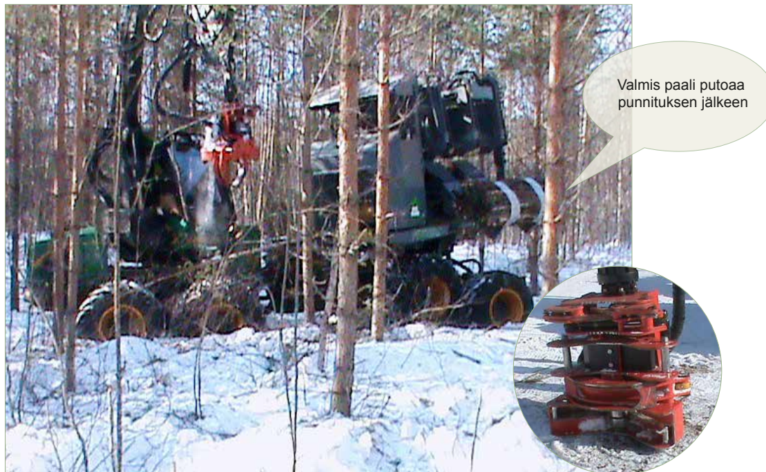
Kuva 1. Fixteri-koneyksikön muodostaa Nisula 280E+ joukkokäsittelyä hakuu-laite, Logman 811FC alus-takone sekä Fixteri FX15a paalain (kuva Yrjö Nuutinen/Metla).
