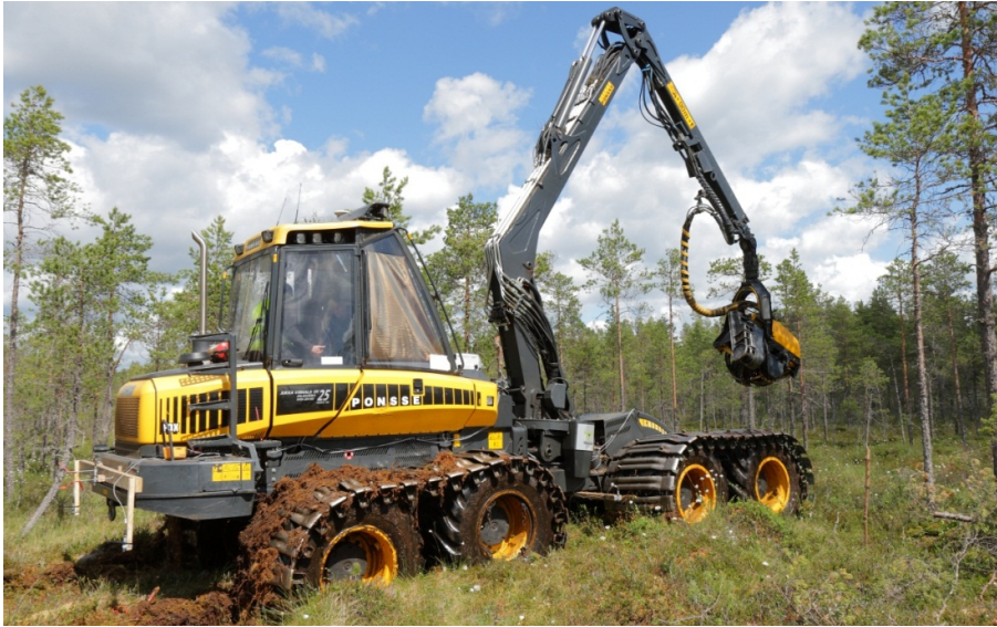
Kuva 6. Ponsse Fox ulomman testiradan pehmeimmällä osuudella. Pyörien uppoamaa ja raiteensyvyyttä mittaavat ultraäänianturit kiinnitettiin hakkuukoneen takana ja telien välissä näkyviin puurakenteisiin telineisiin. (Kuva: Jari Ala-Illomäki/Metla)
