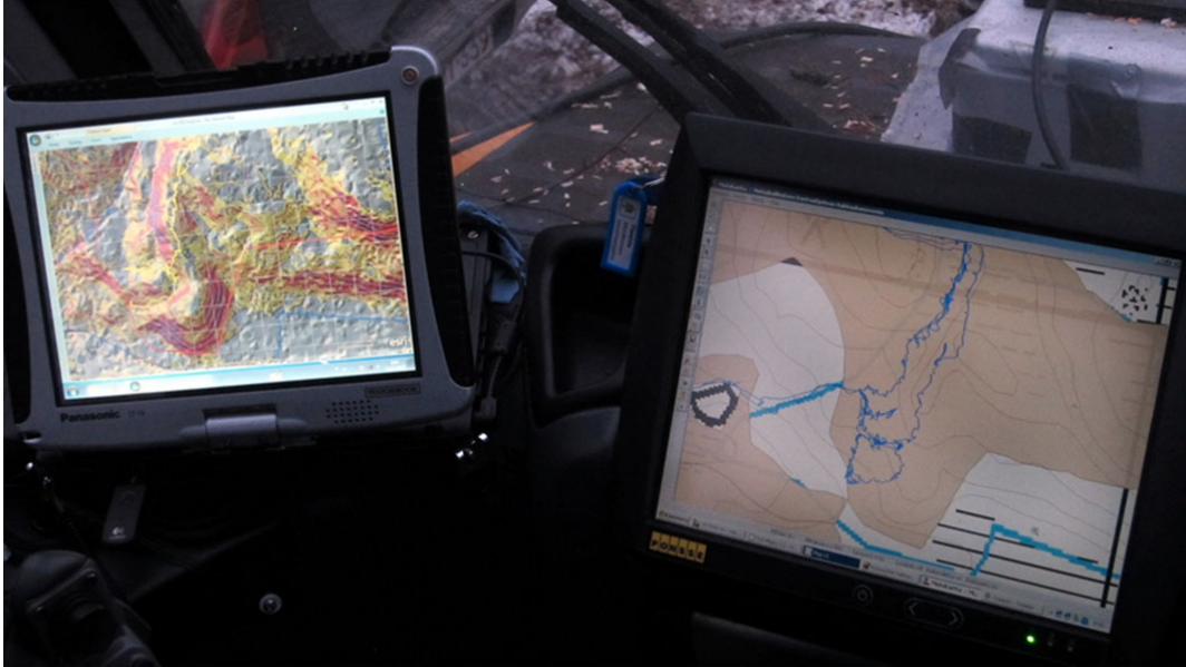
Kuva 4. LoggingMap-demonstraatiot. Tarkkaa karttatietoa esitettiin kuljettajalle hakkuukoneen oman näytön rinnalla. (kuva: Jari Ala-Illomäki/Metla)
