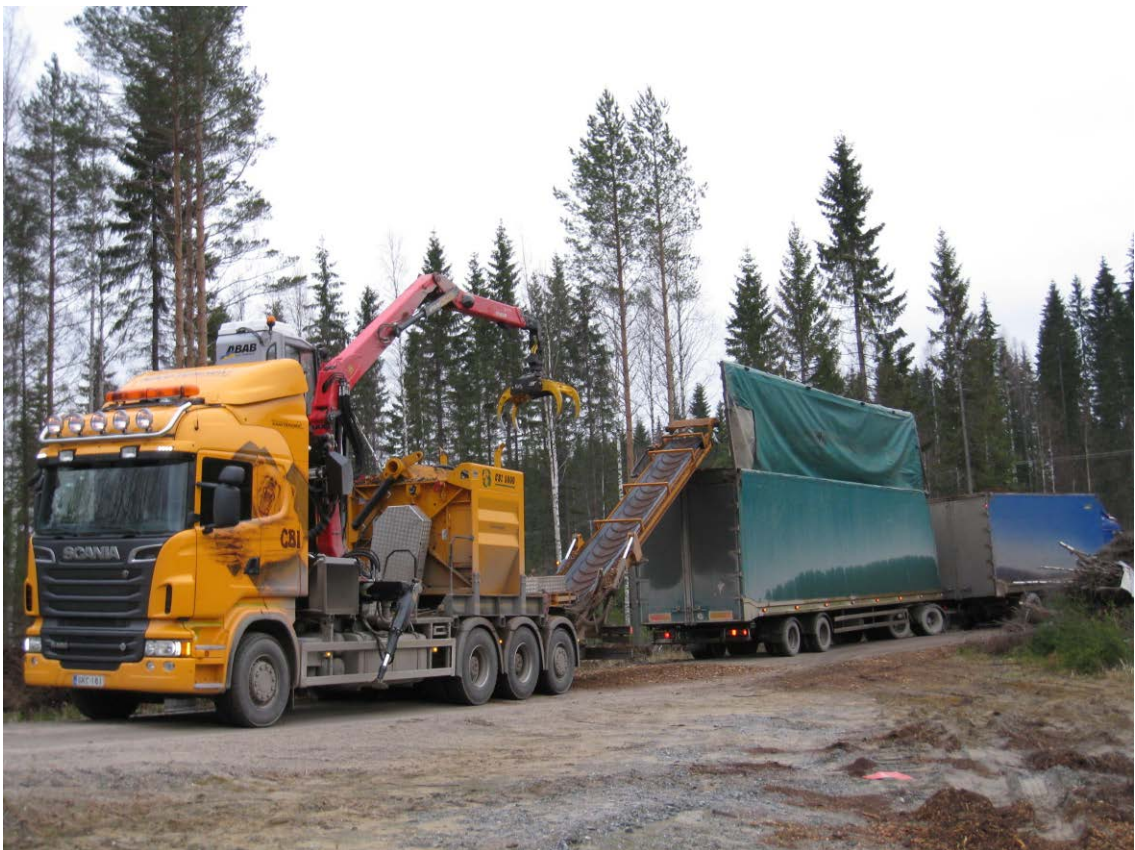
Kuva 5. Latvusmassan murskausta tienvarsivarastolla hakeauton perävaunuun (J. Laitila/Metla).
