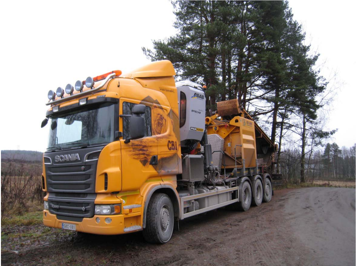
Kuva 2. CBI 5800 murskain valmiina siirtymään uudelle työmaalle (J. Laitila/Metla).
