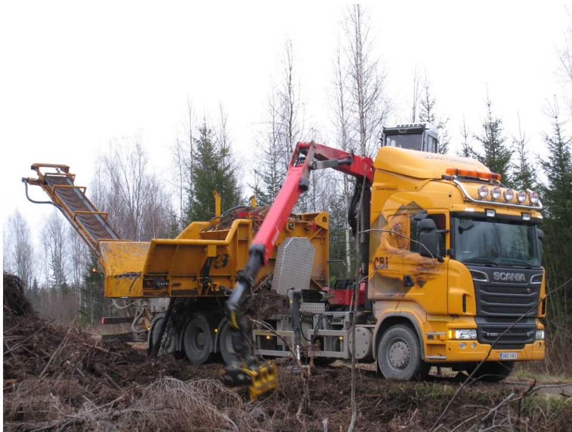
Kuva 1. Kuorma-autoalustainen CBI 5800 murskain siistii varastokasan pohjaa ja odottaa hakeautoa tienvarsivarastolla (J. Laitila/Metla).
