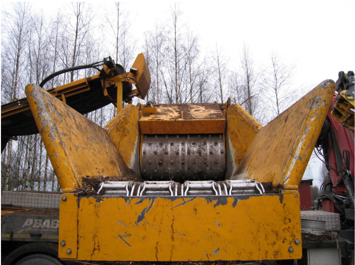
Kuva 3. CBI 5800 murskaimen syöttöpöytä (J. Laitila/Metla).
