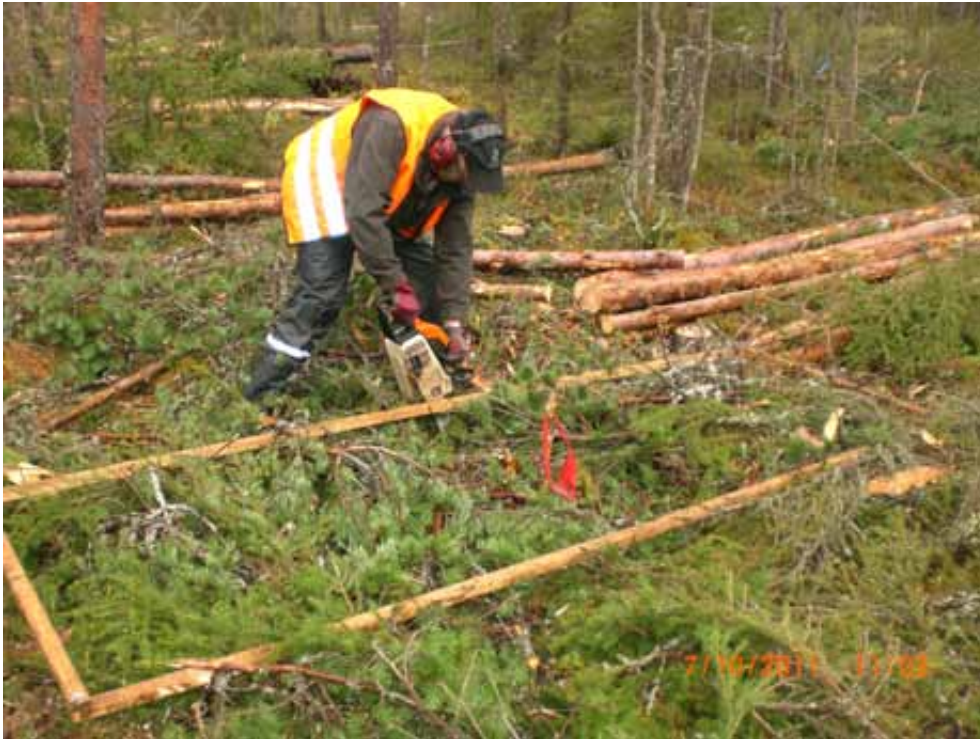
Kuva 6. Hakkuutähteen mittausta maastossa (Tero Takalo/Metla).
