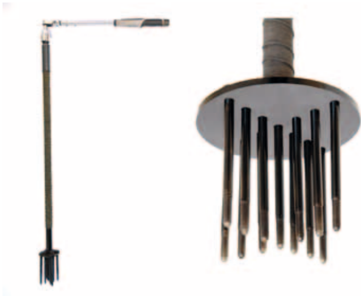
Kuva 5. Kantavuuden mittauksessa käytetty piikkisiipikaira (Jari Ala-Illomäki/Metla).
