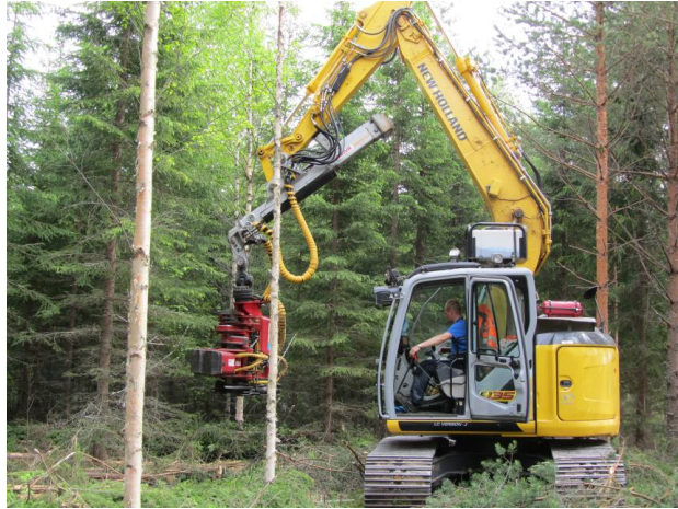
Kuva 3. New Holland Kobelco E 135 B SR kaivukoneharvesteri ja Naarva EF 28 hakkulaite. Kuva Metla/Kari Väätäinen.
