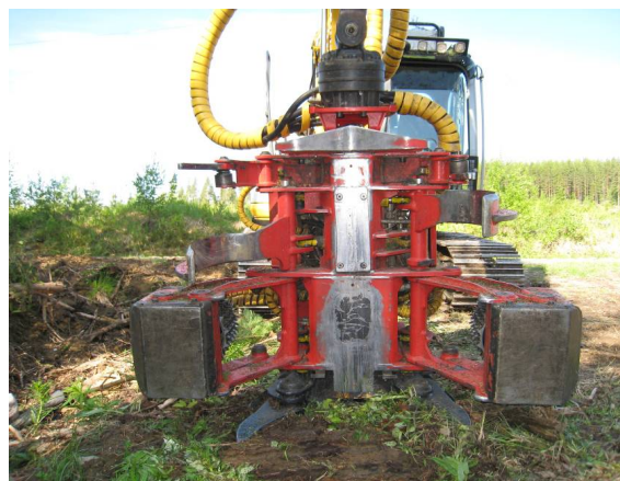
Kuva 2. Naarva EF 28 hakkuulaite edestäpäin kuvattuna. Kuva Metla/Juha Laitila.
