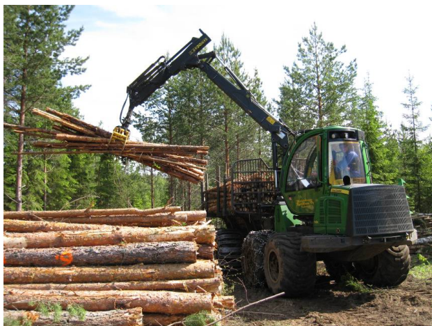
Kuva 10. Mäntykuitupuun kuormainvaakamittauksen toinen vaihe tienvarsivarastolla purkamisen yhteydessä (Juha Laitila/Metla).
