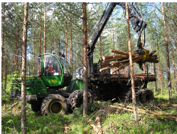
Kuva 9. Mäntykuitupuun kuormainvaakamittauksen ensimmäinen vaihe palstalla kuormauksen yhteydessä. Kuva Metla/Juha Laitila.
