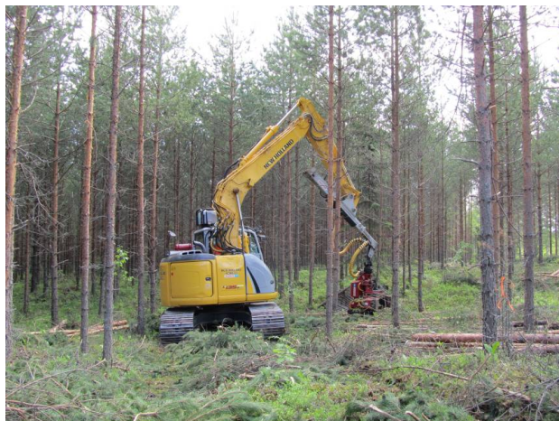
Kuva 5. Kaivukoneharvesteri hakkuukoealalla Kuva Metla/Kari Väätäinen.
