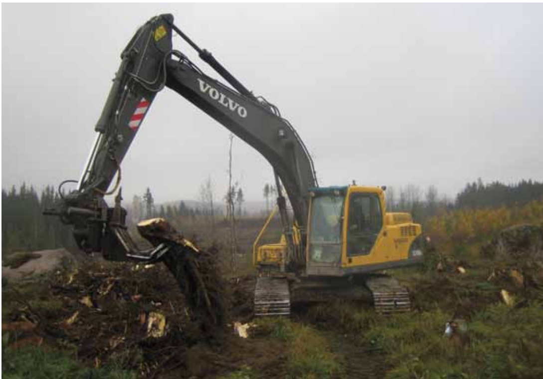
Kuva 1. Kantohara Väkevä (A. Hirvonen Oy) ja kaivukone Volvo EC 210B LC. (Kuva: Aki Jouhiaho)
