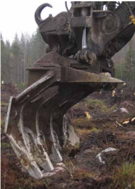
Kuva 3. A. Hirvonen Oy:n kantohara Väkevä (vas.) ja Tervolan Konepaja Oy:n kantoharvesteri Pallari KHM-140 (oik.). (Kuvat: Aki Jouhiaho)
