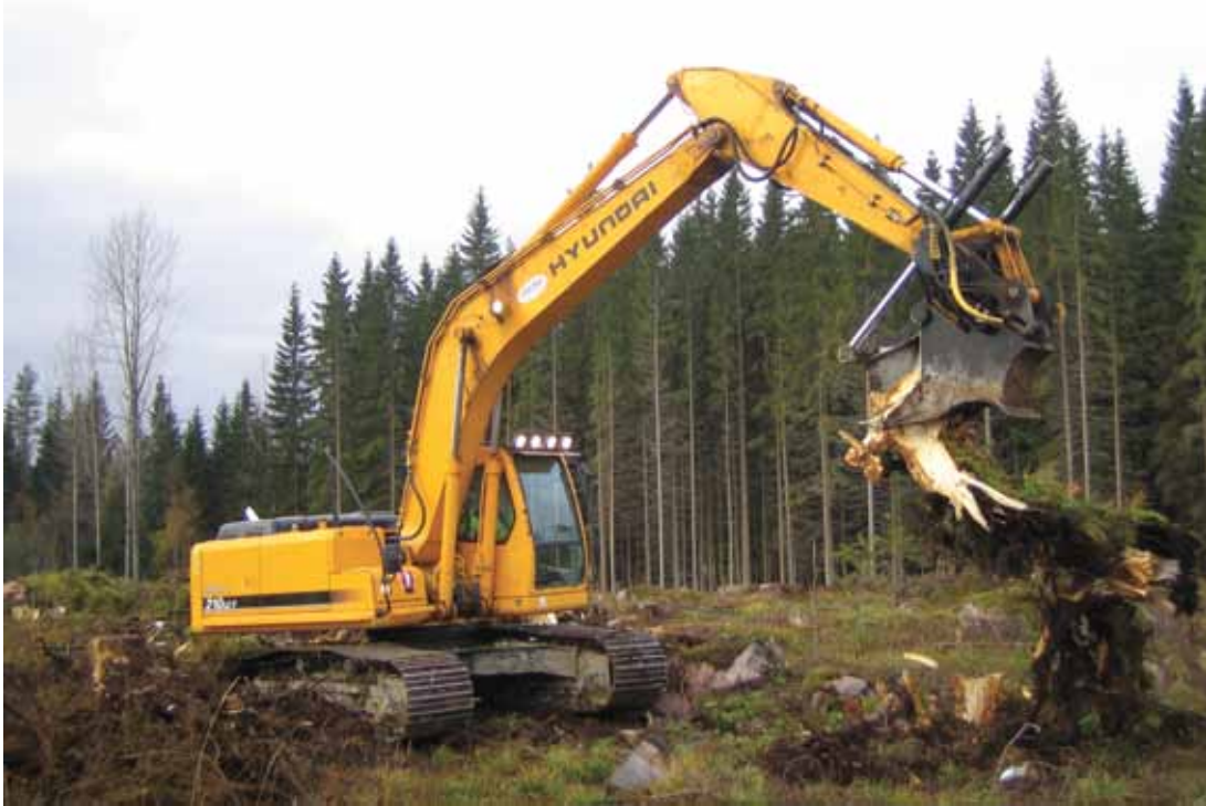
Kuva 2. Kantoharvesteri Pallari KHM-140 (Tervolan Konepaja Oy) ja kaivukone Hyundai 210 LC-7. (Kuva: Aki Jouhiaho)
