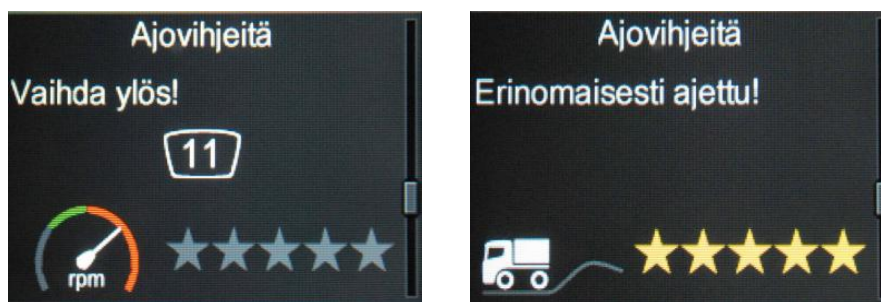
Kuva 3. Opaste-esimerkkejä Scanian valmistamasta kuljettajaa opastavasta taloudellisen ajamisen tukijärjestelmästä (Scania Driver Support © Scania).
