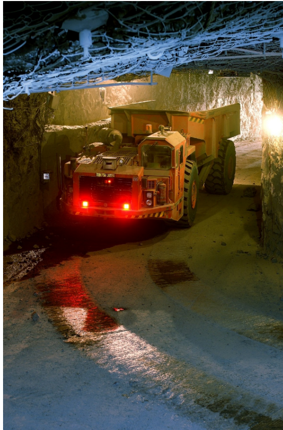
Kuva 4. AutoMine-järjestelmässä navigointijärjestelmä päivittää ajoneuvon sijaintia jatkuvasti ja ohjaa kuljetusta ja lastausta (© Sandvik AutoMine).
