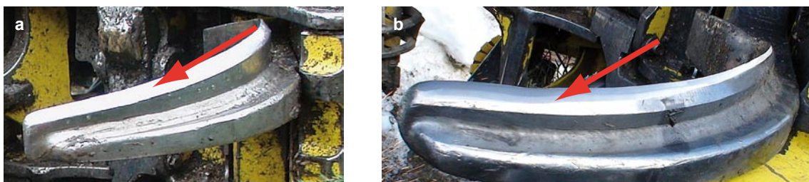
Рис. 3.21. Нож боковой верхний: а – правильный угол резания в секторе обрезке сучьев толстых стволов; б – неправильный угол резания в секторе обрезке сучьев толстых стволов.
