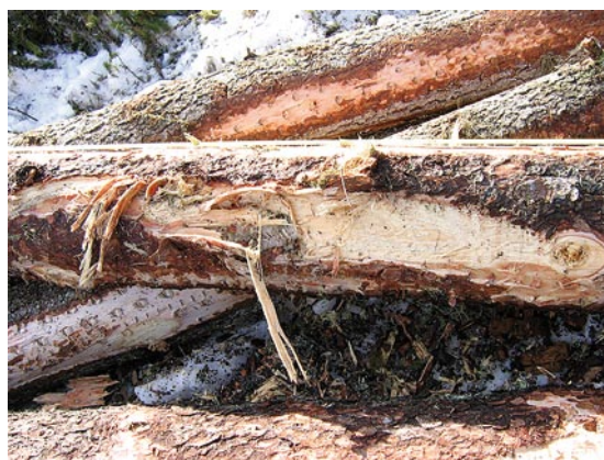
Рис. 3.24. Повреждения ствола приводными вальцами.
