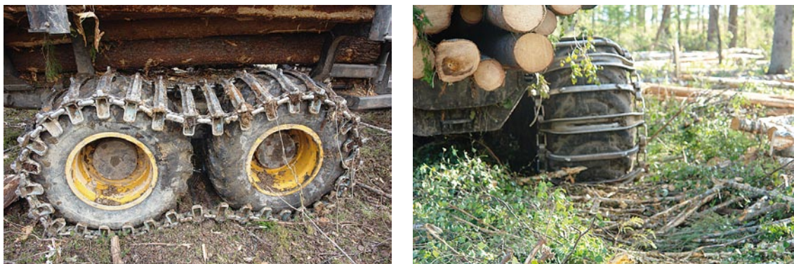
Рис. 3.19. Колесные гусеницы и хворостяная подушка.
