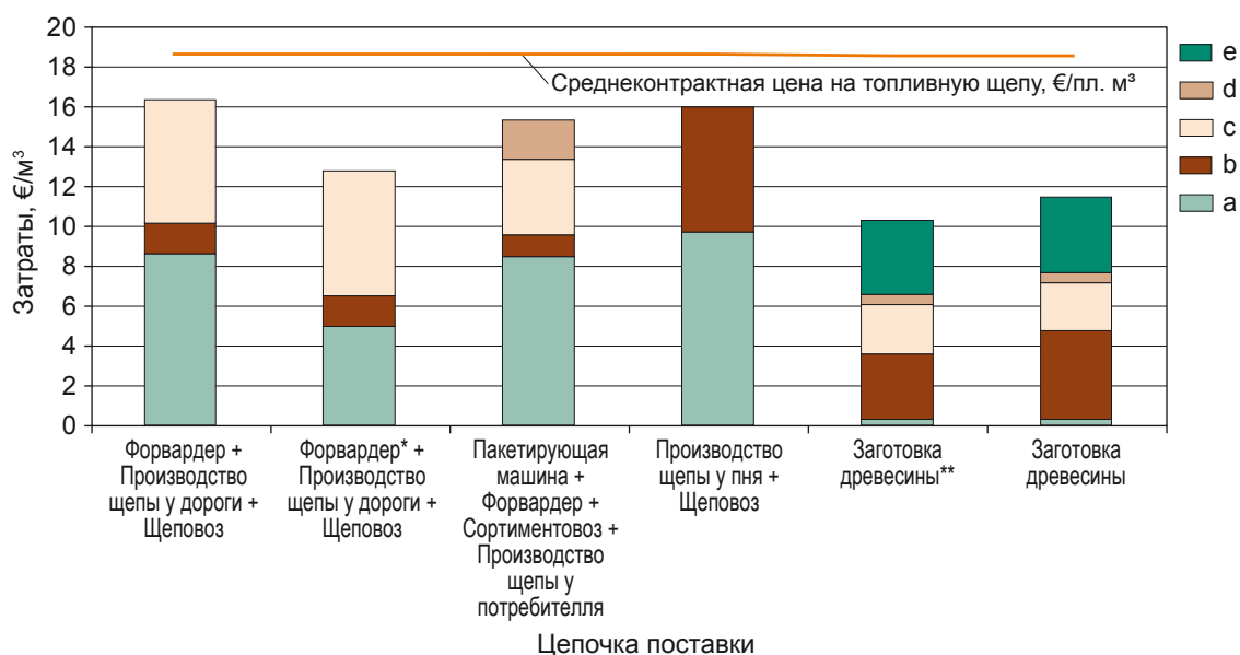
Рис. 3.5. Структура затрат в цене 1 плотного м 3 щепы при расстоянии 50 км, евро. (Второе насаждение;* - без учета постоянной составляющей затрат на работу форвардера).
