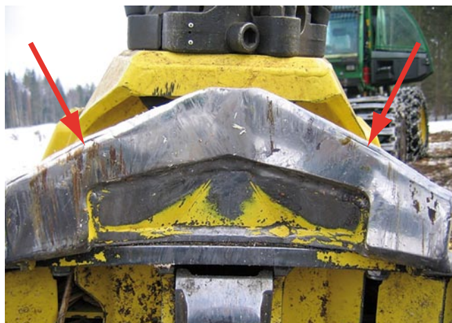
Рис. 3.20. Нож опорный верхний со встречной заточкой по нижней грани режущей кромки.
