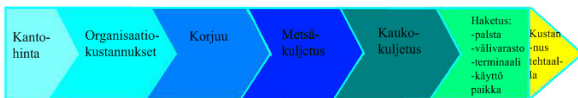
Kuva 1. Metsäenergian tuotannon arvoketjut ja käyttöpaikkahinnan muodostuminen
