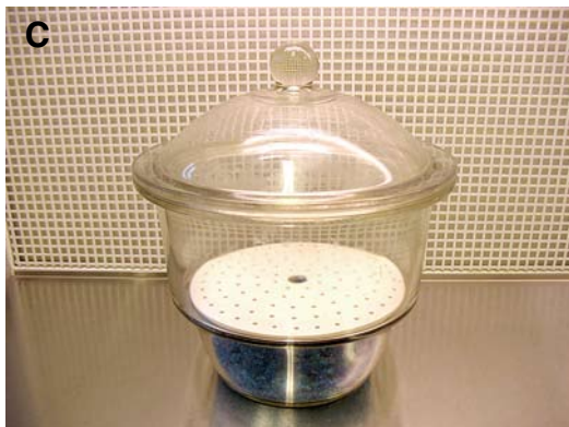
Kuva 58. Siementen kosteuden uunimittauksessa tarvittavat välineet: A) kuivausuuni, B) analysivaaka vähintään kolmella desimaalilla, C) eksikaattori ja D) vähintään 2 kpl kannellisia kuivausastioita ruostumattomasta metallista, lasista tai posliinista. Kuvat: Pekka Helenius.
