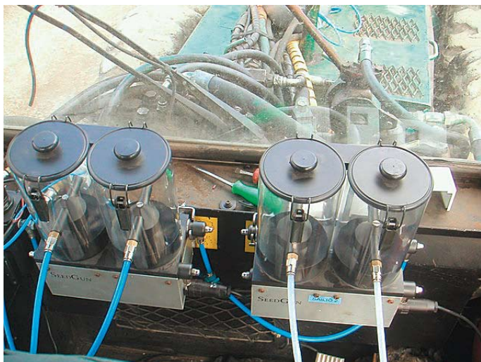
Kuva 52. Kylvölaitteen siemensäiliö. Aurinkoisella ilmalla lämpötila säiliön sisällä voi nousta haitallisen korkeaksi.
