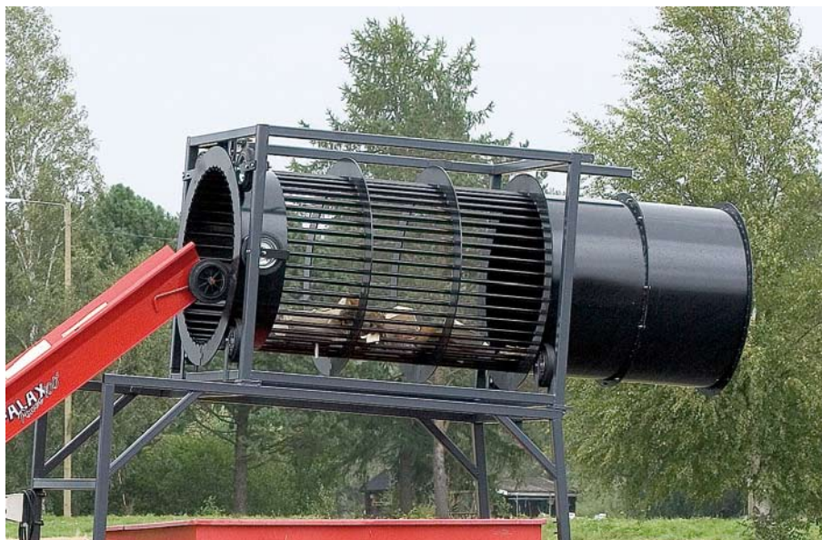
Kuva 13. Polttopuiden puhdistukseen tarkoitettu rumpuseula soveltuu myös käpyjen esipuhdistukseen, kun rummun sisään asennetaan tiheämpi verkko. Kuva: Ylistaron Terästäkomo Oy.
