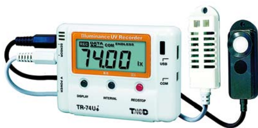
Kuva 55. Valaistusta, UV-säteilyä, lämpötilaa ja kosteutta tallentava dataloggeri, jonka näytöltä voi myös seurata idätysolosuhteita reaaliajassa. Oikealla näkyvät sensorit mahtuvat idätyskuvun alle. Kuva: Perel Oy.
