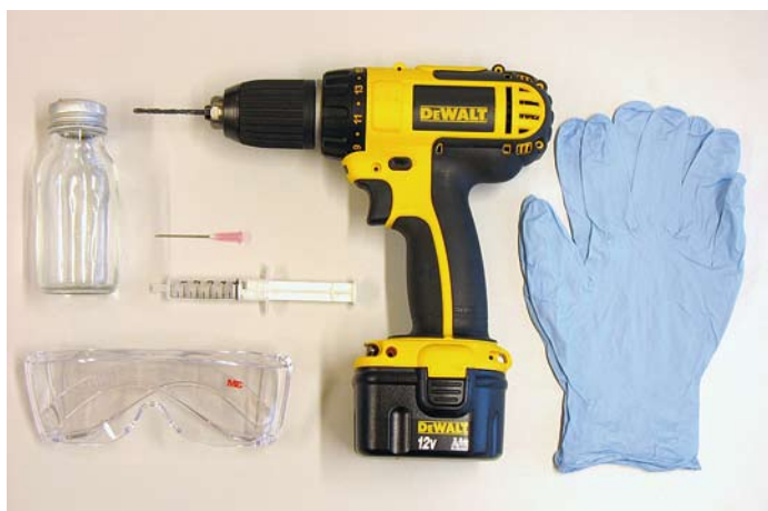
Kuva 3. Gibberelliinihormonin runkoinjektiossa tarvittavat välineet: akkuporakone ja sopiva poranterä (3,2 mm), pipetti tai lääkeruisku porareikään sopivalla kärjellä ja neula liuoksen imemiseen pullosta, gibberelliini-liuos sekä suojalasit ja -käsineet. Kuva: Pekka Helenius.
