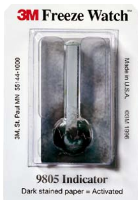
Kuva 31. Vasemmalla lämpötilan laskun alle tietyn raja-arvon paljastava indikaattori (pakkasvahti) ja oikealla lämpökertymää mittaava indikaattori (aikalämpötila). Kuva: Suomen 3M Oy.
