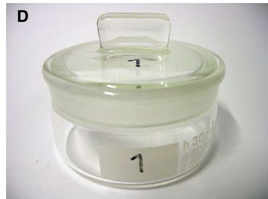
Kuva 58. Siementen kosteuden uunimittauksessa tarvittavat välineet: A) kuivausuuni, B) analysivaaka vähintään kolmella desimaalilla, C) eksikaattori ja D) vähintään 2 kpl kannellisia kuivausastioita ruostumattomasta metallista, lasista tai posliinista. Kuvat: Pekka Helenius.
