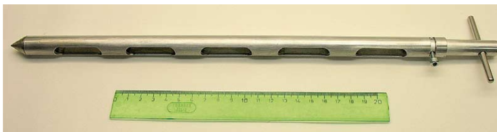
Kuva 40. Alumiinista valmistettu väliseinäallinen lokero-kaira näytteenottoon. Kuva: Pekka Helenius.
