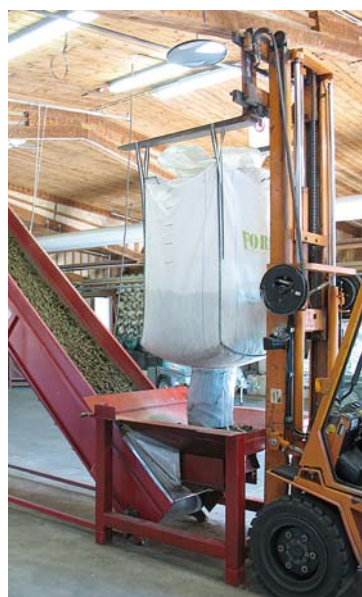
Kuva 9. Täyttö- ja tyhjennysukalla varustettu suursäkkimalli. Täyttösukka voidaan kääriä täyden ajaksi säkin ulkopuolelta alas (säkin kulmissa on reiät, joista nostolenkit voidaan pujottaa läpi). Suursäkki vaatii noin 2,5 metriä vapaakorkeutta tyhjennyspaikalla. Kuva: Pekka Helenius.
