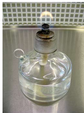
Kuva 44. Pinsetit saa kätevästi desinfioidua siementen laskennan aikana käyttämällä niiden kärjet sprilampun liekissä. Kuva: Pekka Helenius.
