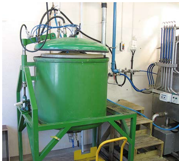
Kuva 48. PREVAC-käsittelyssä käytettävä paineastia. Kuva: Pekka Helenius.
