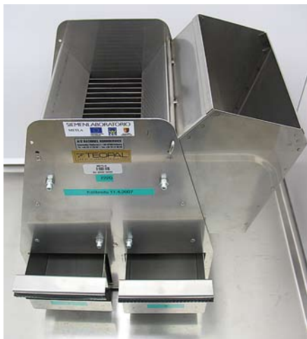
Kuva 43. 18-kanavainen siementen yleisjakolaite (9 kanavaa molempiin alla oleviin astioihin). Jakolaite puolittaa näytteen kahteen yhtä suureen ja ominaisuuksiltaan samanlaiseen osaan. Toisen puolen puolittamista jatketaan kunnes näyte on sopivan suuruinen (~40 g). Ennen puolittamista kokoomanäyte sekoitetaan hyvin laskemalla se pari kertaa jakolaitteen läpi ja yhdistämällä osat. Jakolaitteella voi puolittaa mallista riippuen 3, 5, 10 tai 18 litran kokoisen näytteen. Kuva: Pekka Helenius.
