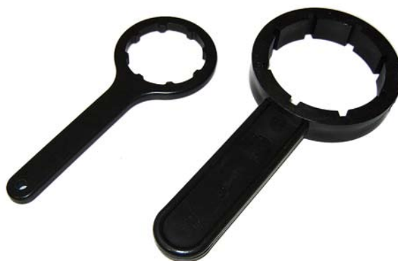
Kuva 28. Muovikorkkien kiristämiseen ja avaamiseen tarkoitettu työkalu. Kuva: Raija Jalonen, Savo-Set Oy.
