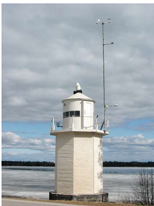
Kuva 20. Asikkalassa Pulkkilanharjun loiston yhteydessä oleva Ilmatieteen laitoksen automaattisääasema. Kuva: Pekka Helenius.
