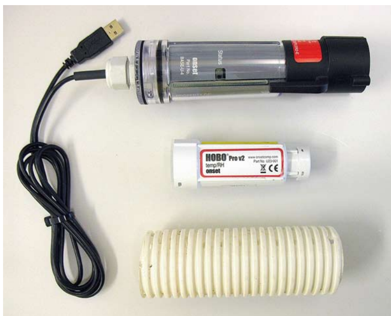
Kuva 19. Lämpötilaa ja suhteellista kosteutta mittaava tallennin (keskellä), tallennetun tiedon siirtoon tietokoneelle tarvittava optinen lukuasema ja tallentimen suojausputki. Kuva: Pekka Helenius.
