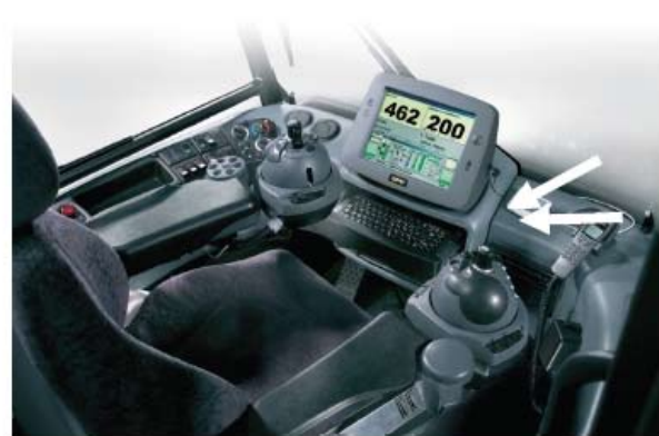
Kuva 39. Puukartan käyttöliittymän mahdollinen paikka yksiotteharvesterissa (Jutila ym. 2007).
