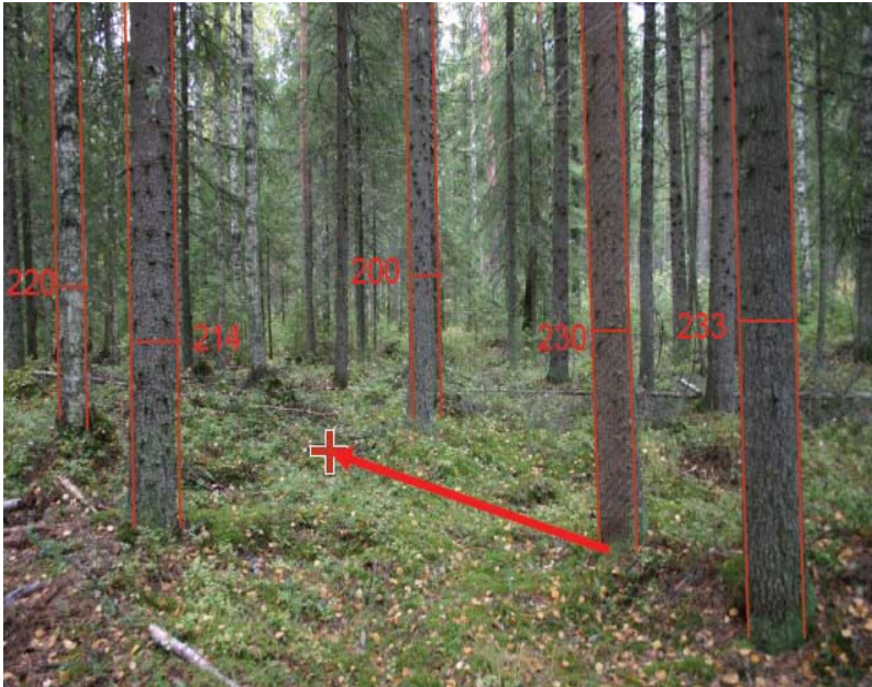
Kuva 38. Visio tulevaisuuden käyttöliittymästä. Järjestelmän harvesterin työskentelyalueella havaitsemien puiden ääriiviivat näkyvät korostettuina kuljettajan havaitseman näkymän päällä. Myös havaittujen puiden läpimitat on merkitty. Kaadettavaksi valitun puun kaatosuunta valitaan kursorilla vetämällä, jolloin syntyvä nuoli näyttää valitun suunnan. (Kuva: Jari Ala-Ilomäki)
