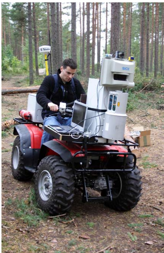
Kuva 15. Mönkijä varustettuna 2D laserskannerilla, 3D laserskannerilla, GPS:llä, IMU:lla ja kameralla. (Kuva: Jari Ala-Ilomäki)
