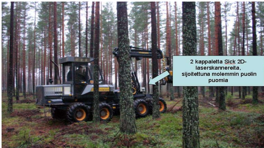
Kuva 16. 2D-laserskannereilla varustettu Ponsse Cobra HS-10 yksioteharvesteri. (Kuva: Jari Ala-Illomäki)
