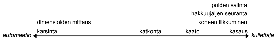
Kuva 2. Yksioteharvesterin toimintojen automatisoinnin nykytila.
