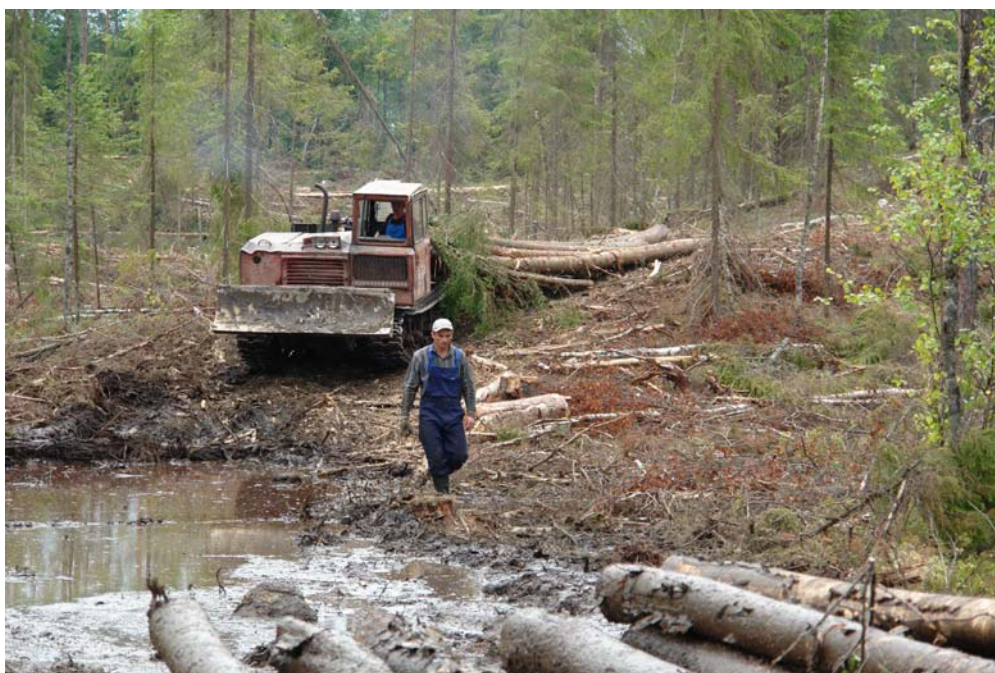
Рис. 3.9 Трелёвочный трактор ТДТ-55. Фото Василия Катарова
