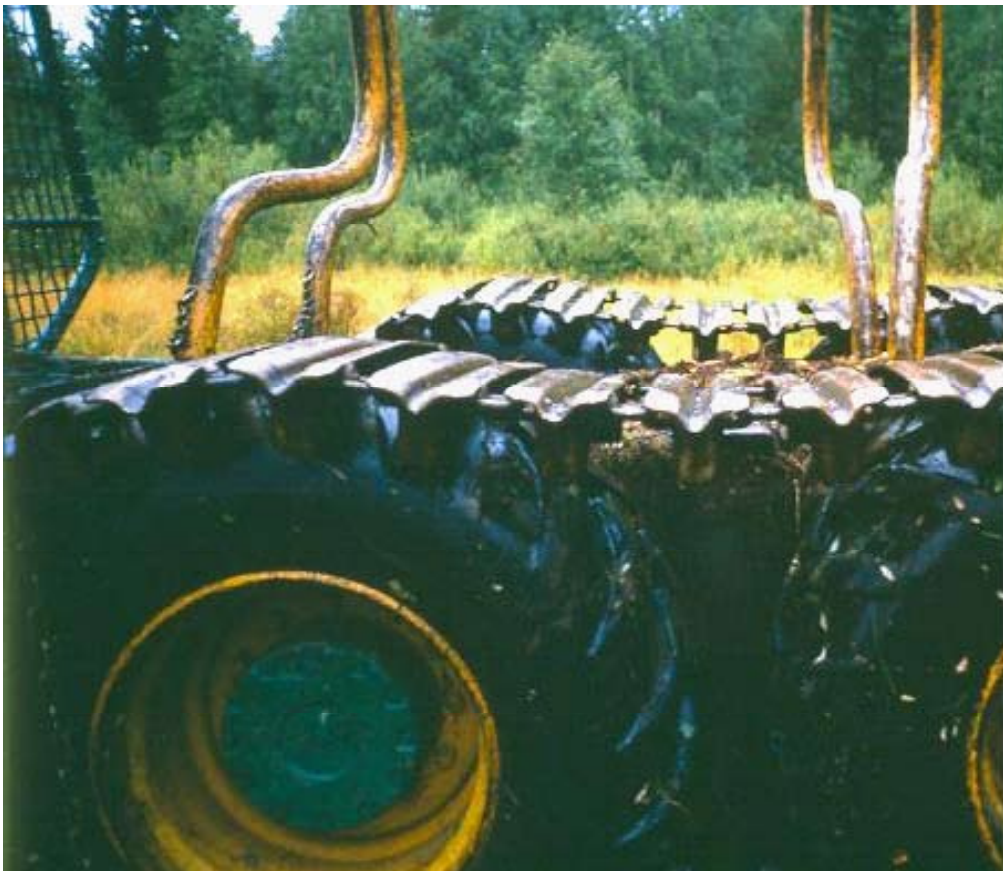
Kuva 4. Marttiin konepajan Metsähallitukselle suunnittelema pehmeiden maiden erikoistela (Vilko 1986). Telan leveys on 900 mm.
