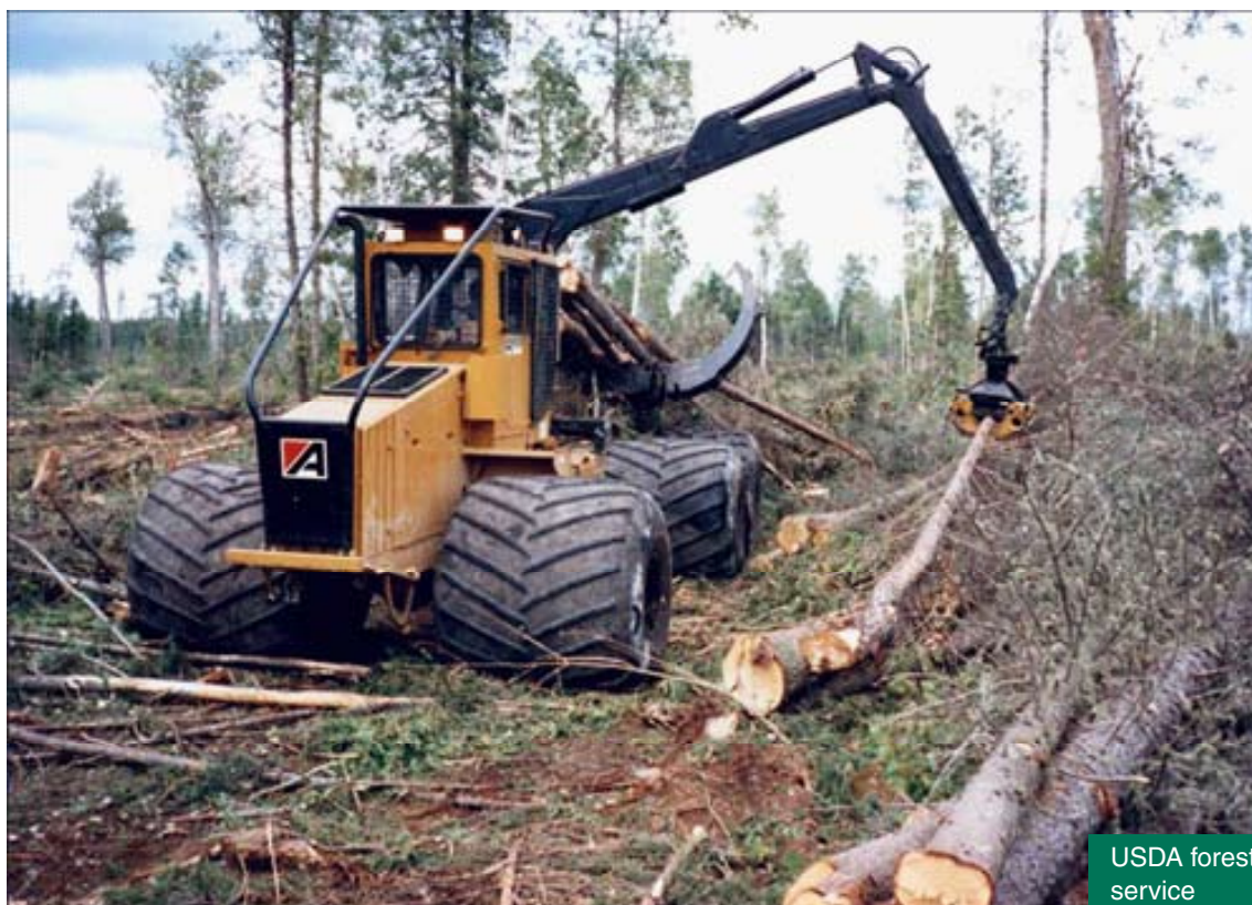
Kuva 9. Ylileveät renkaat runkojuontokoneessa (Harvesting systems 2007).
