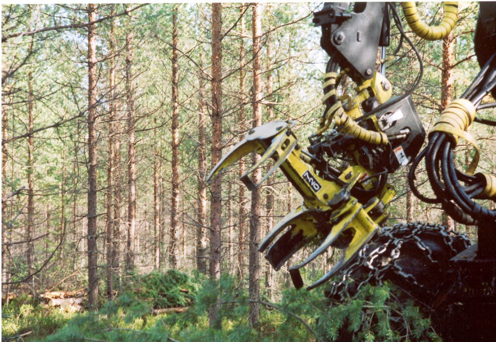
Kuva 15. Timberjack 720 keräävä energiapuukoura nuoren männikön harvennuksella (J. Laitila 2002).
