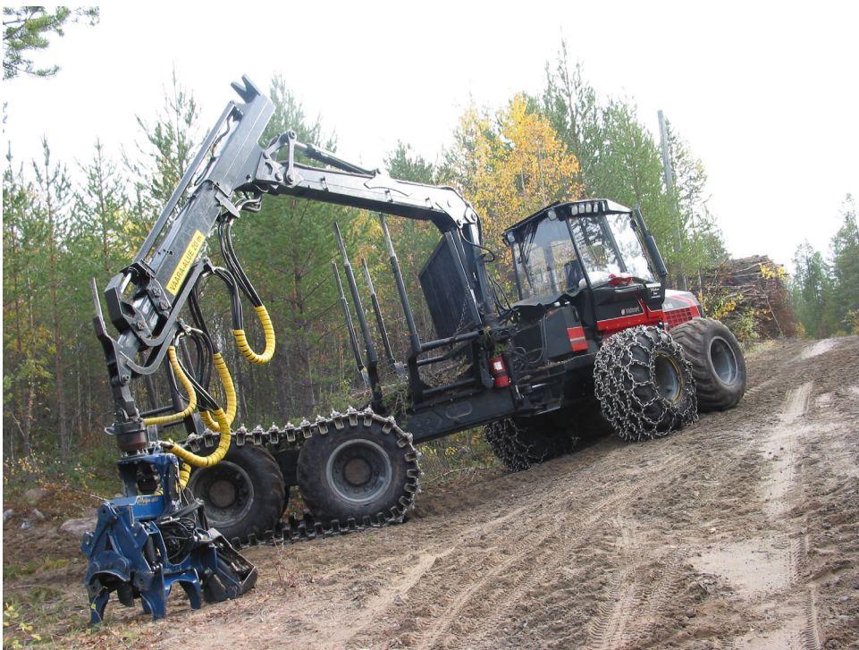
Kuva 37. Yhdistelmäkoura 400 E & Valmet 840 kuormatraktori Posiolla (J. Laitila 2002).
