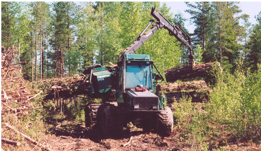
Kuva 39. Fiberpac 370 B paalaamassa pienkokopuuta Lestijärvellä (J. Laitila 2002).
